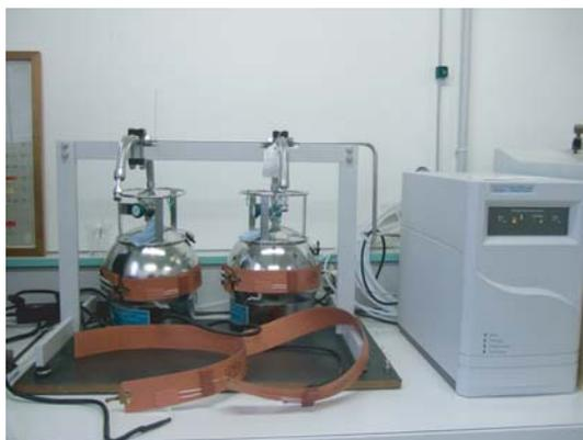
**Figure III.2.** – Système de conditionnement des canisters (CLEANER (Modèle 3100, Entech).
