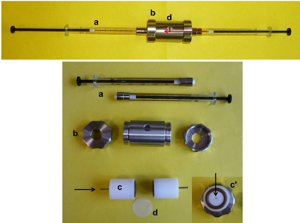
**Figure V.2 :** Photographie d'un dispositif d'extrusion : monté (en haut) et démonté (en bas) ; a) seringues Hamilton, b) corps métallique de serrage, c) parties en plastique permettant le maintien de la membrane, d) membrane poreuse. Les parties en plastique sont traversées de part en part par un canal métallique central (cf. flèches).
