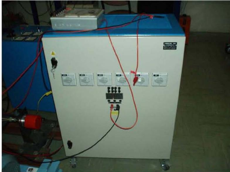
Figure IV.3. Caisse de charge résistive.
