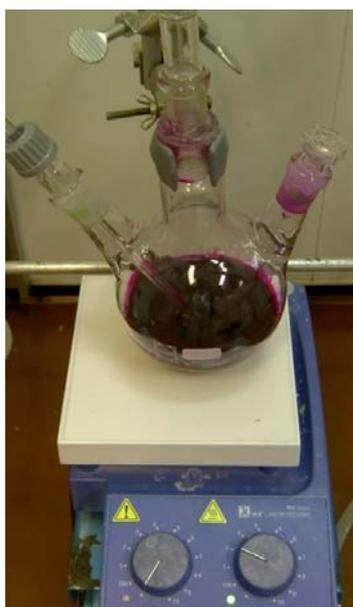
Figure 25: Bullage d'ammoniac (sec) à travers la solution de marquage pour le pMDI
