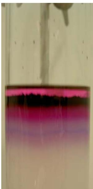
Figure 26: Chromatographie sur colonne de la solution de marquage de chlorure de méthylène
