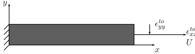
FIG. 2.1 – Barreau en traction uniaxiale
