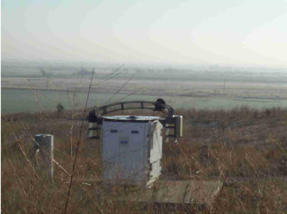
Figure 99 : WSI (Whole Sky Imager) faisant partie de l'instrumentation permanente du SGP.
