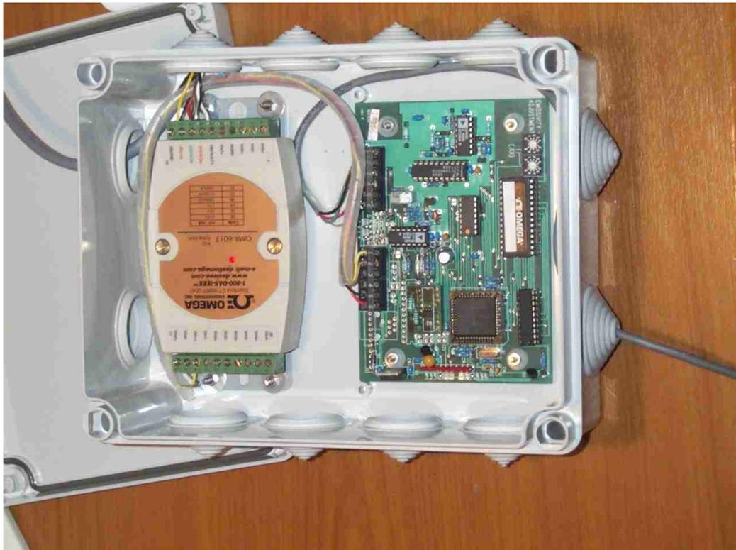
Figure 44 : Boîtier électronique contenant la carte et le multiplexeur pour le test monocapteur
