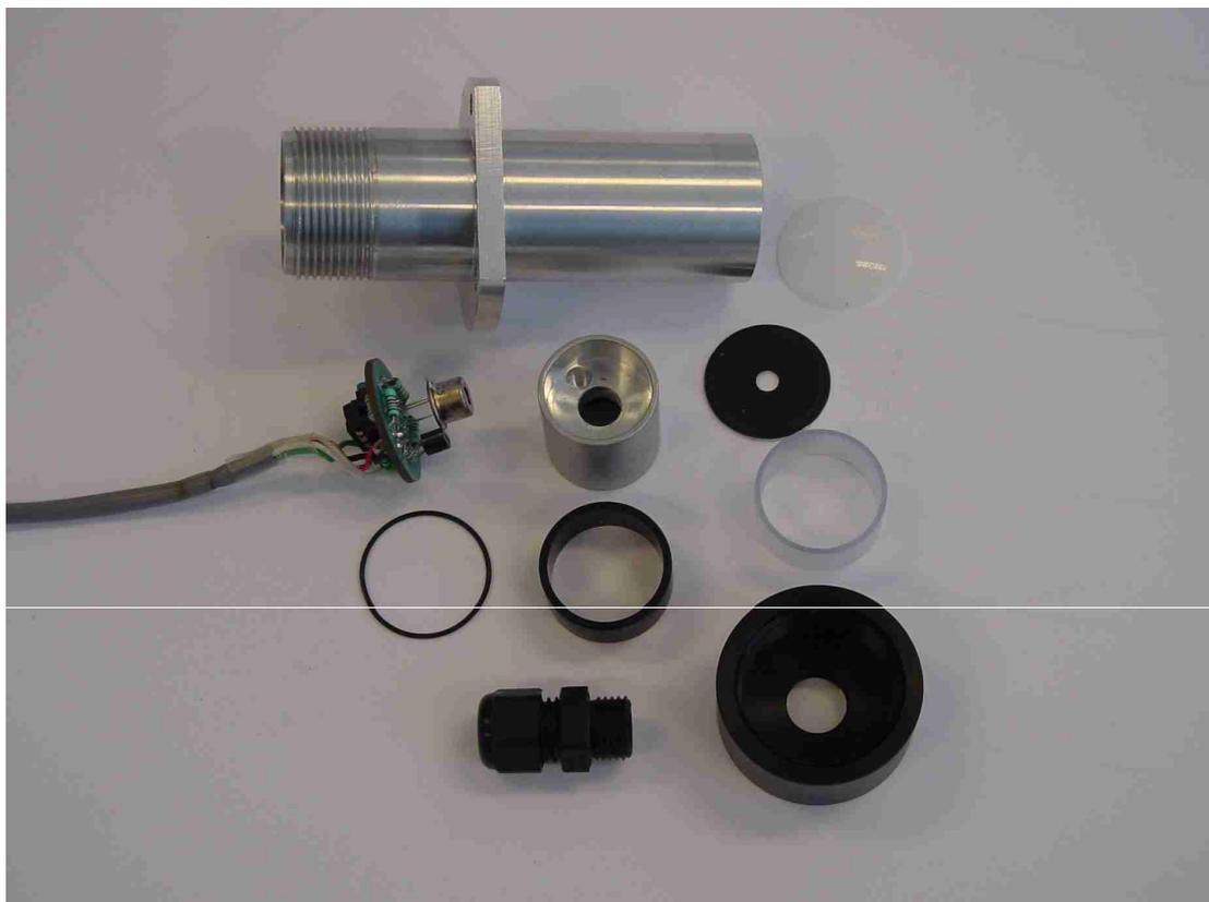
Figure 39 : Vue éclatée du pyromètre OMEGA après modification pour application météorologique
