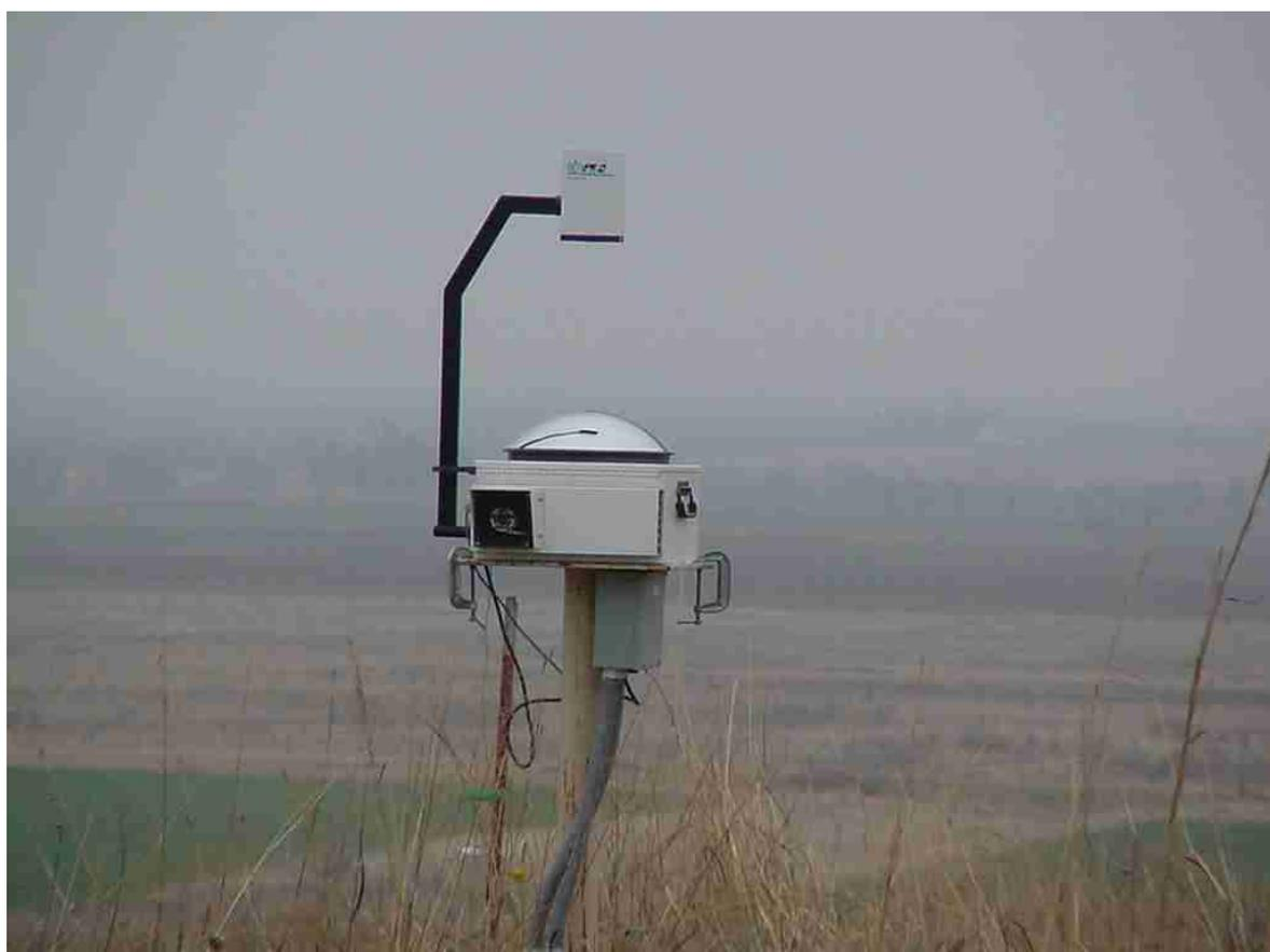
Figure 98 : TSI 880 faisant partie de l'instrumentation permanente du SGP.
