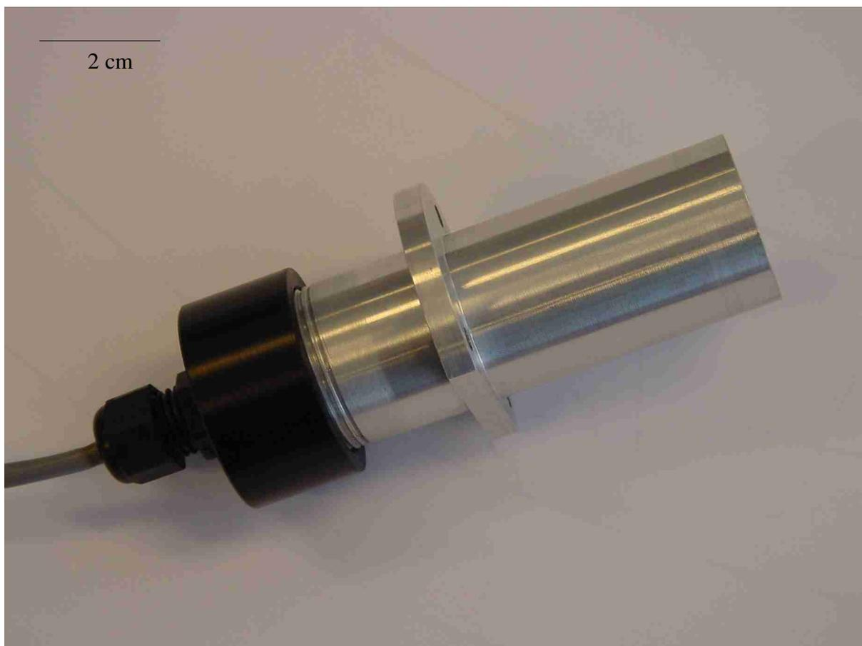
Figure 40 : Capteur OMEGA monté après modification pour applications météorologiques
