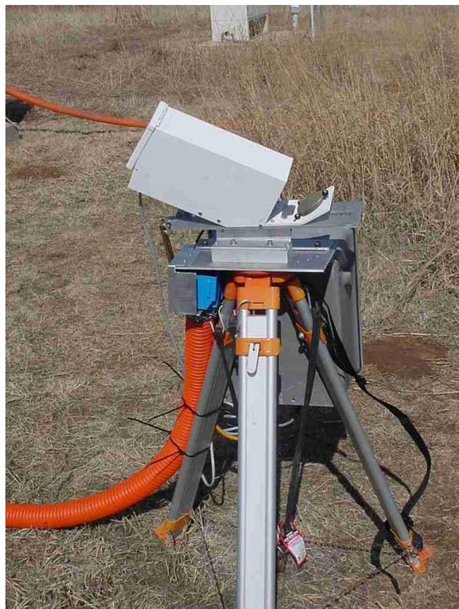
Figure 100 : IRT faisant partie de l'instrumentation permanente du SGP.
