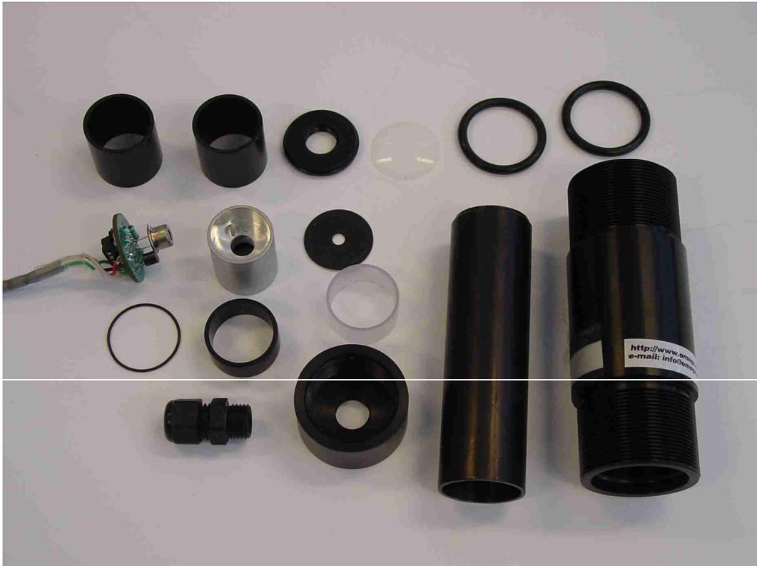
Figure 38 : Vue éclatée du capteur OMEGA dans sa configuration d'origine.
