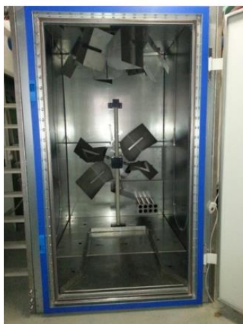
Figure 14 : Dispositif d'exposition A : Photo de la chambre réverbérante B : Dispositif électronique de la chambre, en rouge les ajouts réalisés pour le signal 26GHz
