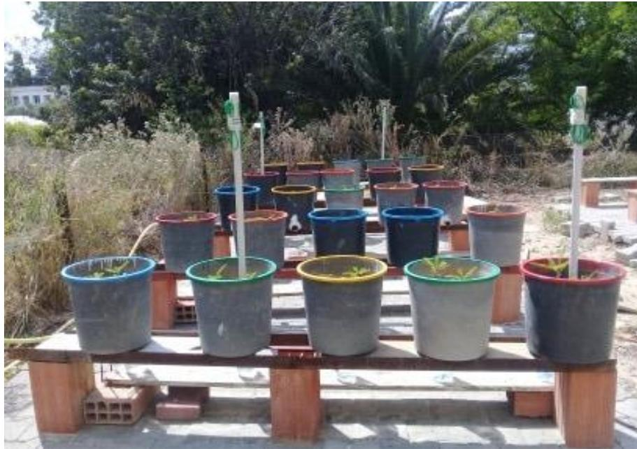
**Figure 2.9** : Implantation des tensiomètres watermark dans les pots.
