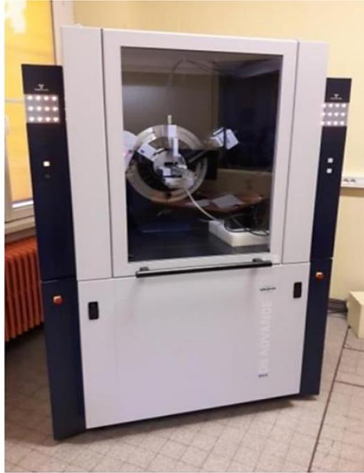
**Figure 2.6 :** Diffractomètre D8 Advance Eco.
