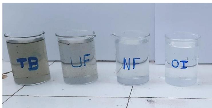
**Figure 2.4:** Observation de l'effet des traitements sur la coloration des effluents textiles.
