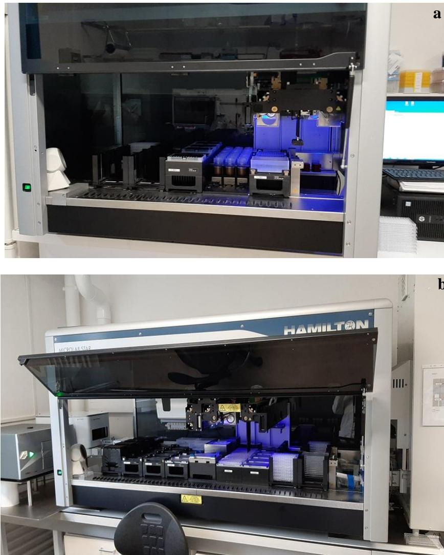
**Figure 2.14** : La plateforme robotisée Hamilton. a-plateforme de répartition de la suspension du sol dans les microplaques ; b- plateforme de l'analyse de l'activité enzymatique.
