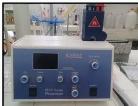
Photo 2 : Spectrophotomètre de flammes (Jenway, PFP7, France).
