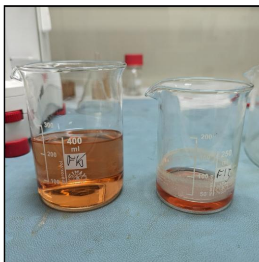
Figure IV-2 — Photos des solutions de deux échantillons, préparés à des intervalles de temps distincts, obtenues après lavage du filtre à l'acétone
