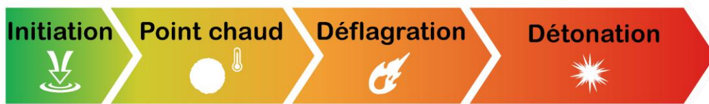
Figure I-3 — Evolution d'une détonation inspirée de Risse et al. [51]
