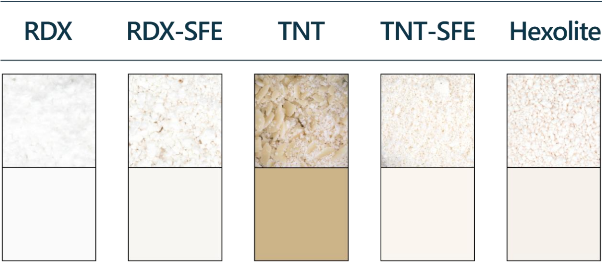
Figure IV-3 — En haut : photos des échantillons de RDX et TNT avant et après SFE. En bas : couleur moyenne associée
