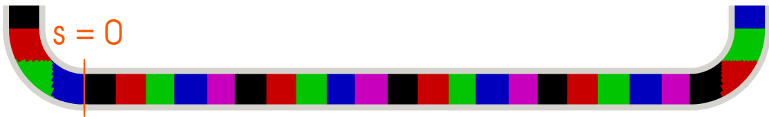
FIGURE 4.6 – Représentation du découpage en cellZone dans la ligne liquide horizontale pour former l'abscisse curviligne.
