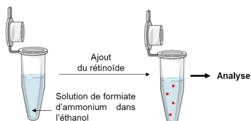
Figure 88. Les différentes étapes de la préparation des deux types d'échantillons. Le liquide transparent illustre l'isopropanol. Le liquide bleu clair montre la solution de formiate d'ammonium dans l'éthanol. En rouge est représenté le rétinoïde étudié. En noir sont illustrées les protéines de la matrice.
