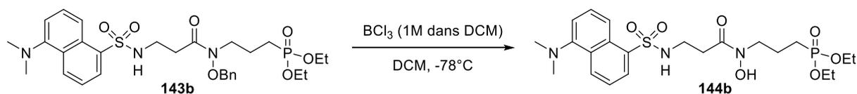
Schéma 29. Réaction de déprotection du groupement benzyle en présence de trichlorure de bore ( $\text{BCl}_3$ ).
