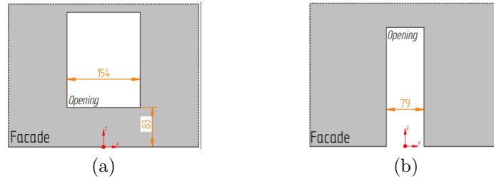
FIGURE 3.5 : Schéma des ouvertures du pilote expérimental, d'après [98] (dimensions en mm). (a) Fenêtre. (b) Porte.
