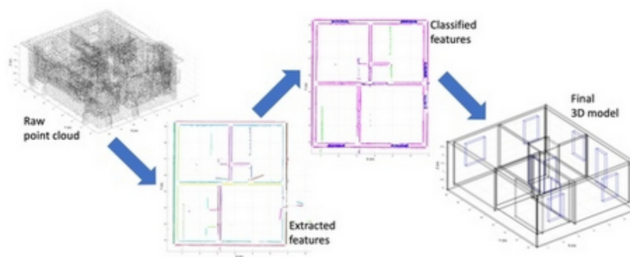
FIGURE 2.6 : Utilisation de la télédétection par laser pour reconstruire l'architecture des bâtiments, d'après [114]
