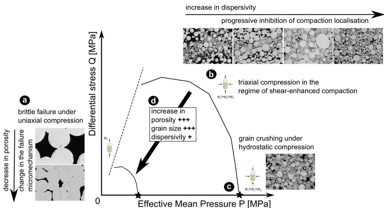
**Figure 8** Influence de la porosité, de la taille des grains et du degré de polydispersivité sur le comportement mécanique et les modes de rupture des roches. Plus une roche est poreuse, formée par de gros grains et polydisperse (ou hétérogène en termes de distribution de tailles
