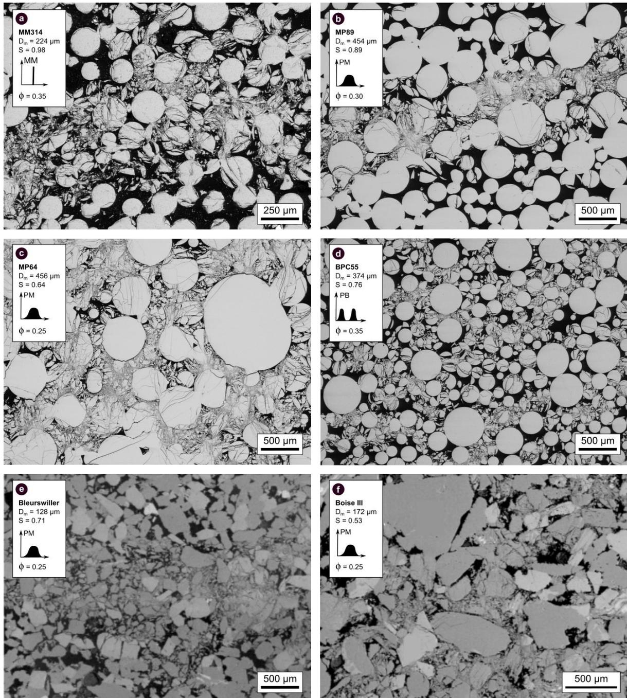
**Figure 7** Images de microscopie électronique à balayage de figures de déformation formées lors de la compression triaxiale d'échantillons synthétiques plus ou moins polydisperses (a-d) et des grès naturels (e) Bleurswiller et (f) Boise III (Cheung et al., 2012). Des bandes de compaction sont visibles dans les échantillons synthétiques et naturels les plus homogènes
