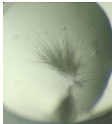
Figure 72: Cristaux de peptide 5M<sub>L</sub> en oursins avec aiguilles longues et isolées (conditions de cristallisation : 2.5 mg/mL, 50 mM d'HEPES à pH=7.4 et 1M de sulfate d'ammonium)
