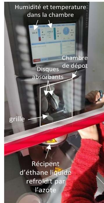
Figure 94 : Dépôt d'une grille de Cryo-TEM au Vitrobot.
