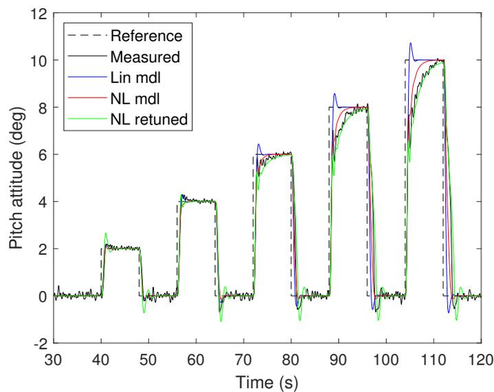
Figure 6 – Essai de suivi de consigne d'un projectile obtenu par co-design. “*Lin mdl*” désigne le modèle de synthèse, “*NL mdl*” le modèle de validation original et “*NL retuned*” sa variante ajustée
