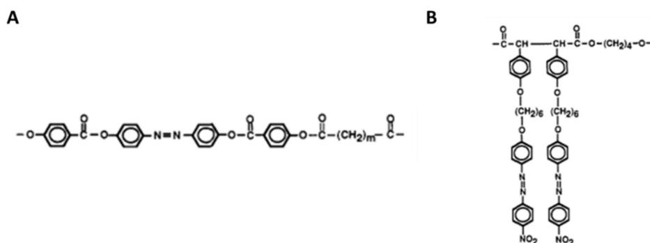
Figure I.24 : Structure de polymères azoïque. A) Groupe azoïque sur la chaîne principale B) Groupe azoïque intégrés sur les chaînes pendantes du polymère.<sup>96</sup>
