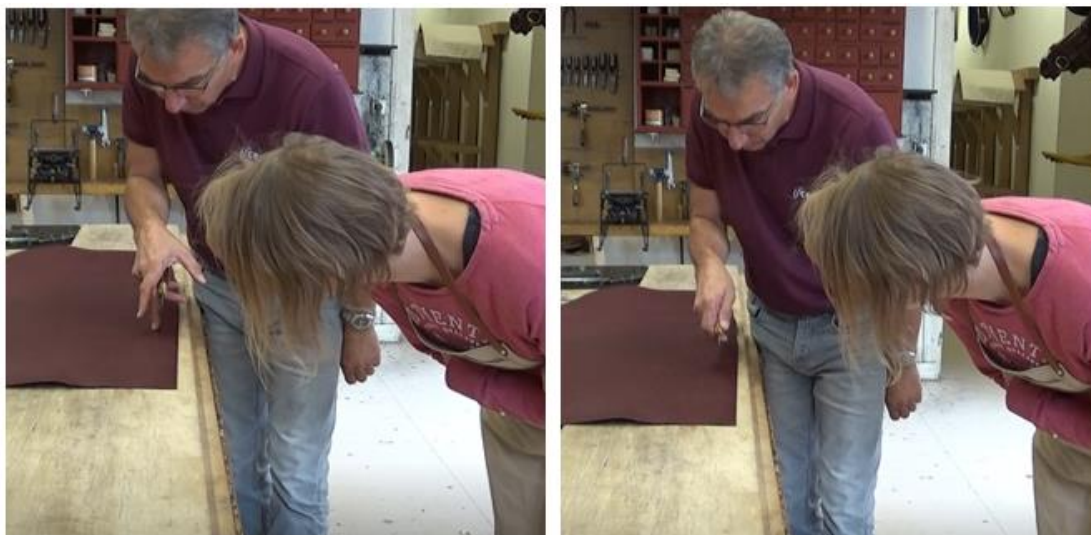
Illustration 27 : Le majeur plaqué contre la lame comme guide de l'inclinaison du couteau
