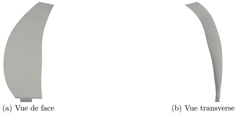
FIGURE IV.9 – Modèle aux éléments finis de la pale Open Rotor défini sur SAMCEF
