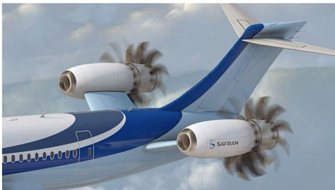
FIGURE I.9 – Représentation de l'installation de l'Open Rotor en queue de fuselage
