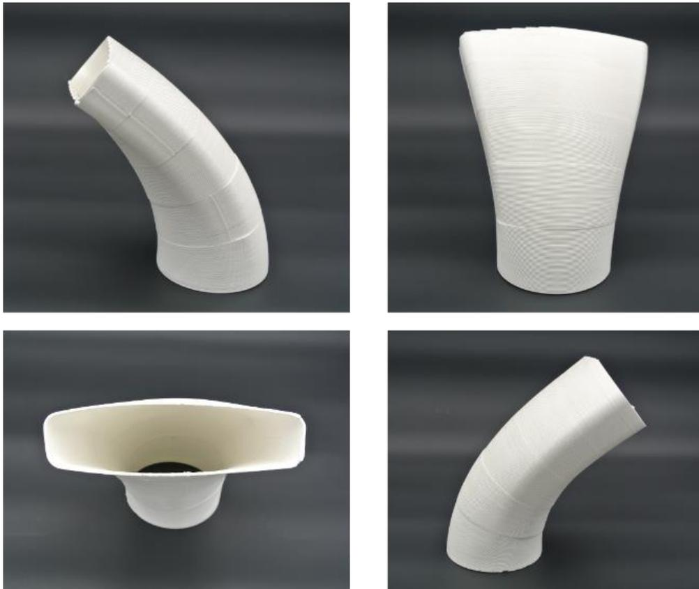
Figure 60 : fabrication additive de pièces en polymère fondu de grandes dimensions, réalisation de la tuyère
