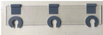
FIGURE 2.18 – Règle imprimée en 3D utilisée pour conserver une disposition des capteurs identique
