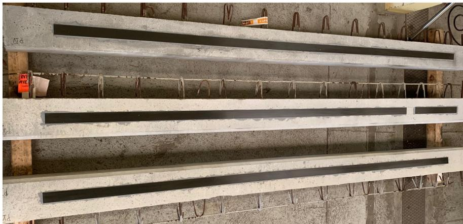
FIGURE 2.4 – Assemblages collés béton-composite poutre : BC-Po
