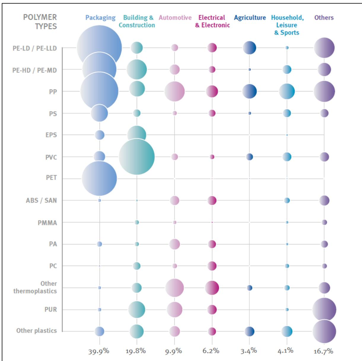
Figure I-5 : Consommation européenne en matière plastique en 2018 en fonction du type de polymère et du domaine d'utilisation [23].
