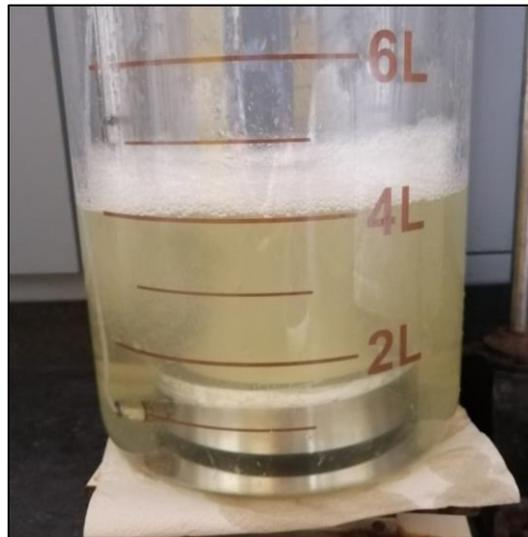
**Figure V-7 :** Photo du réacteur rempli de l'eau de l'étang de l'Estomac avec bullage.
