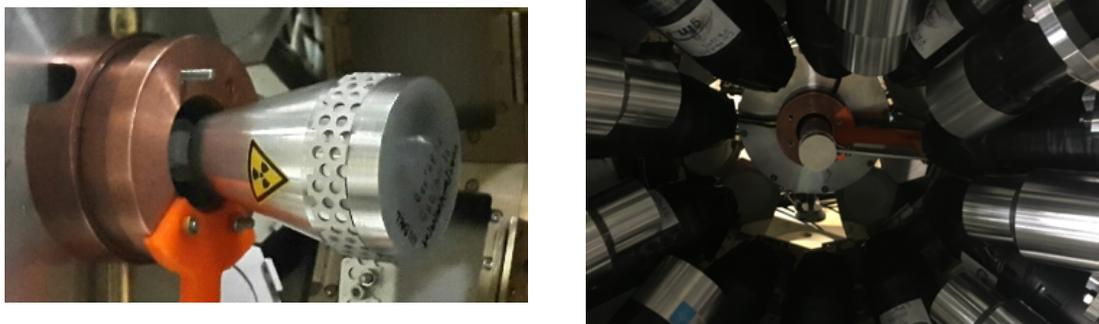
FIGURE 2.2 – À gauche : Photographie de la cible de  $^{nat}\text{Th}$  qui a été utilisée lors de la campagne  $\nu$ -Ball. Elle est accolée à l'extrémité de la source de neutrons LICORNE. À droite : Photographie de la cible d' $^{238}\text{U}$  placée au centre du spectromètre  $\nu$ -Ball.
