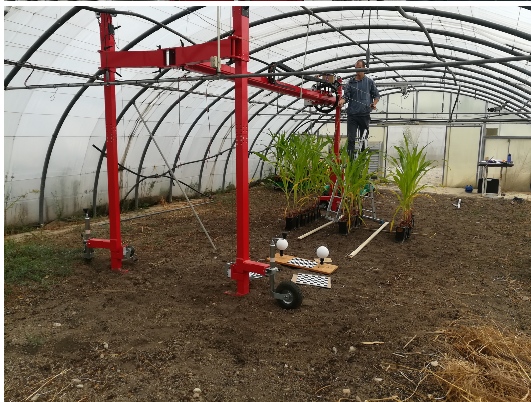
Fig. 1.20.: Montage global des capteurs, du champ de maïs et de Phénofixe pour l'acquisition.
