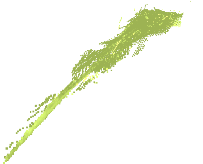
Fig. 4.28.: Un nuage de points du jeu de données LiDAR (voir 1.1 qui présente des points aberrants, des zones d'occultation et quelques problèmes de recalage.
