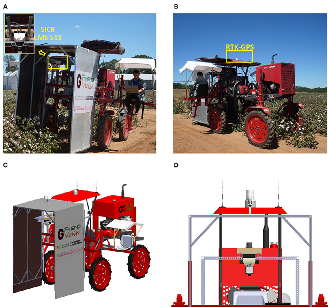
Fig. 1.2.: Illustration du système d'acquisition de Sun et al. (2018). (A) vue avant de la plateforme d'acquisition; (B) vue arrière la plateforme d'acquisition; (C) modèle 3D de la plateforme d'acquisition; (D) Visualisation centrée sur les capteurs.
