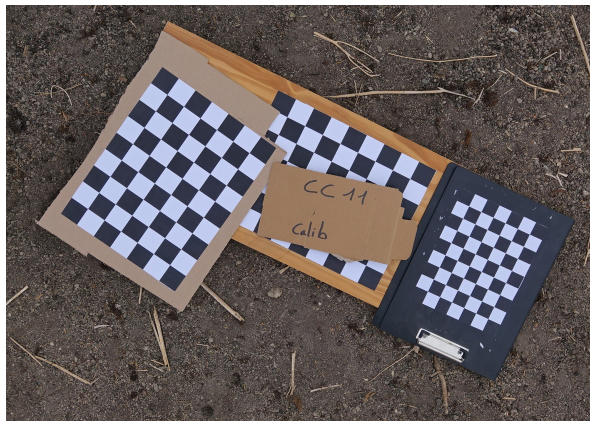
Fig. 1.12.: Image des mires et informations de reconnaissance. De gauche à droite, mire "brune", mire "sol", mire "noire".
