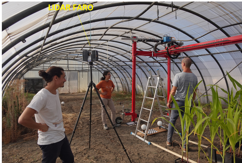
Fig. 1.19.: Positionnement du LiDAR FARO pour l'acquisition.
