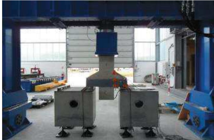
Figure III-8 : Mise en place d'une console courte en béton armé
