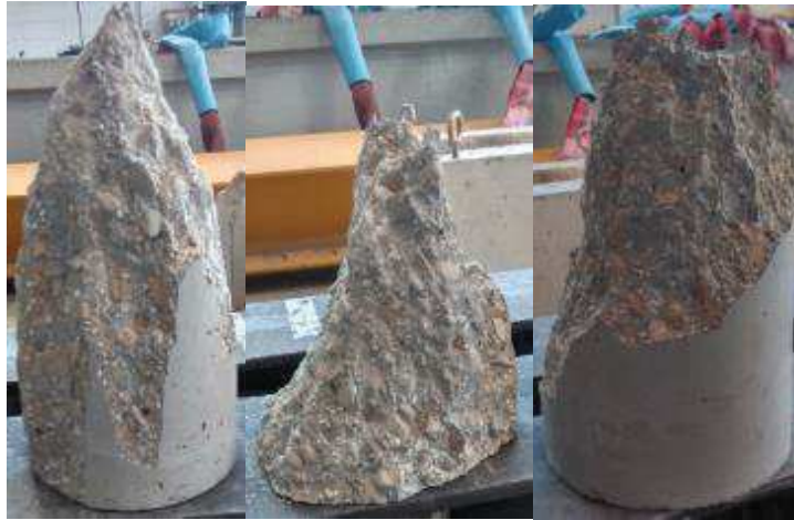
Figure II-12 : État de rupture des éprouvettes cylindrique, 16x32, en béton courant
