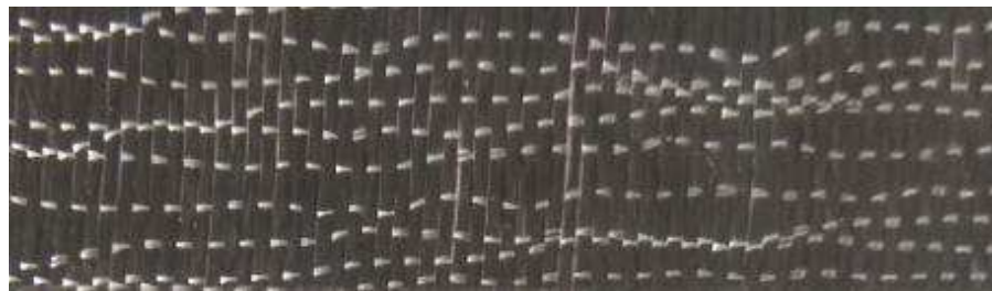
Figure II-18 : Tissu en fibres de carbone unidirectionnelle
