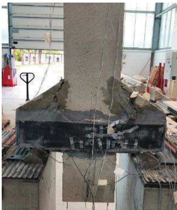
Figure III-17 : État de fissuration et de rupture de poteau-console réparé, renforcé et instrumenté par les jauges de contrainte.
