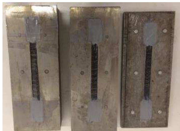
Figure II-19 : Préparation de plaques composites de tissus en fibres de carbone unidirectionnelles dans les moules
