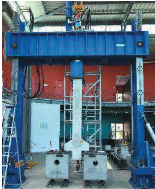
Figure III-9 : Mise en place du Poteau-console courte en béton armé
