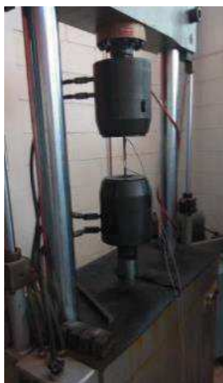
Figure II-13 : Dispositif expérimental d'un essai de traction simple
