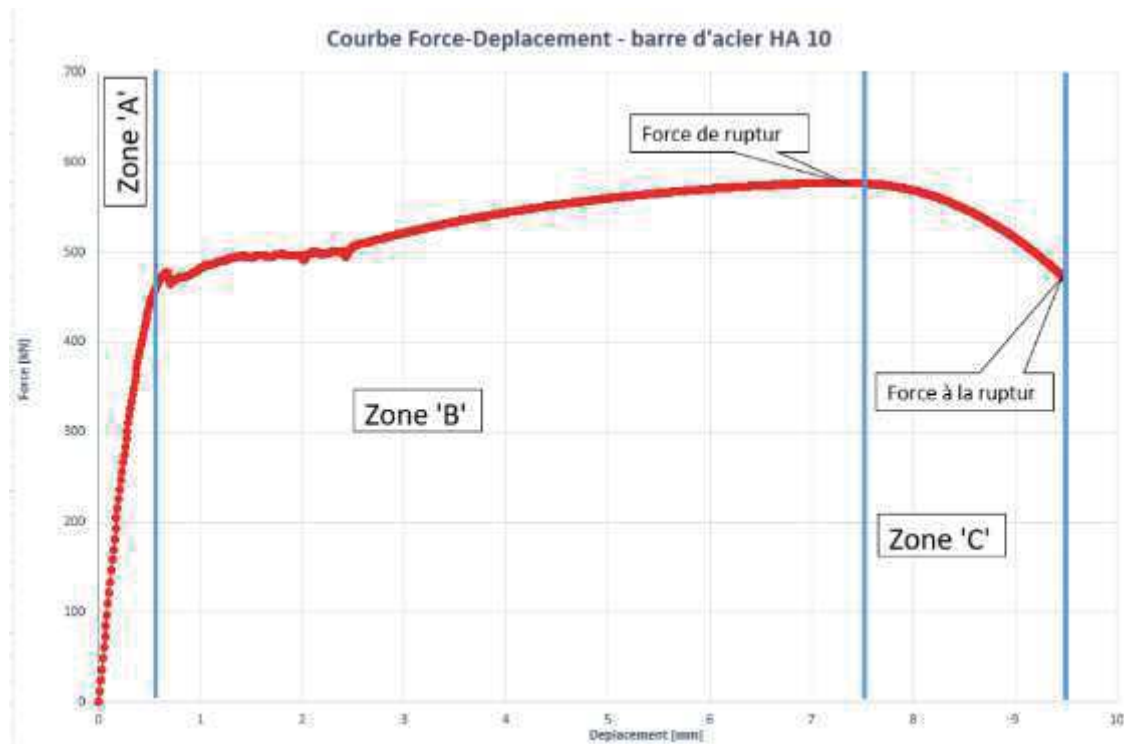
Figure II-15 : Comportement d'une barre d'acier en traction simple
