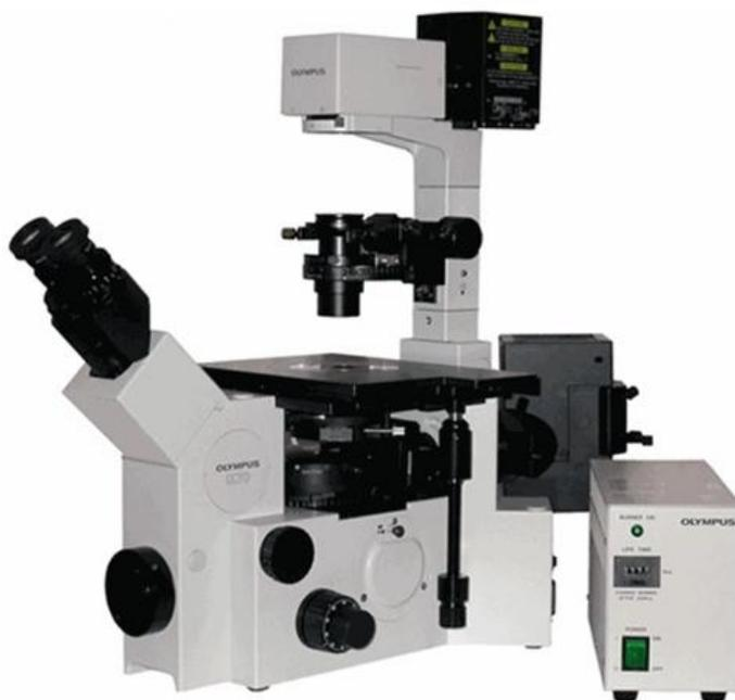
Figure 65 : Microscope à statif inversé *Olympus® IX70* (182)
