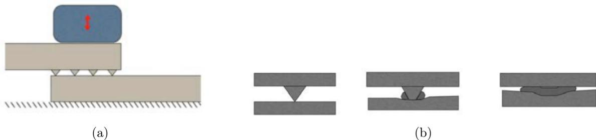
FIGURE I.2 – (a) Principe du soudage par ultrasons et (b) déformation visqueuse des directeurs d'énergie [24]
