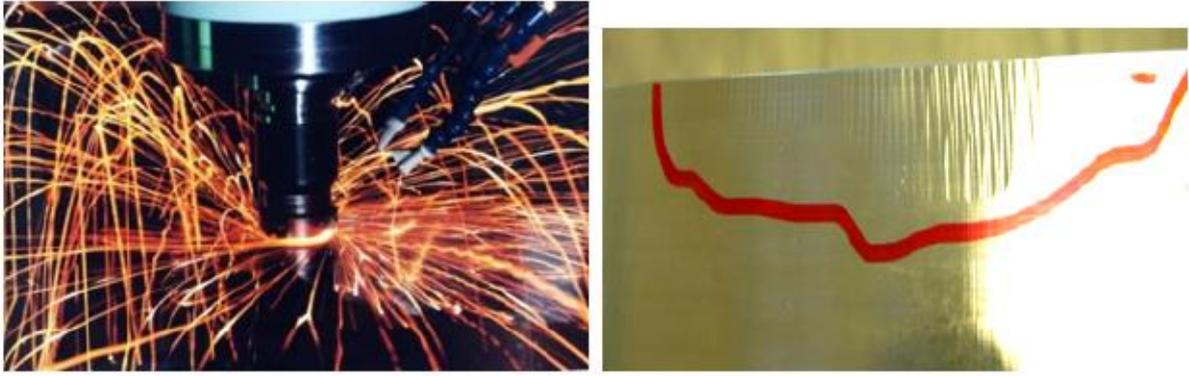
**Figure 1.** Exemple de bris d'outil (à gauche) et de broutement (à droite) [Godreau, 2017].
