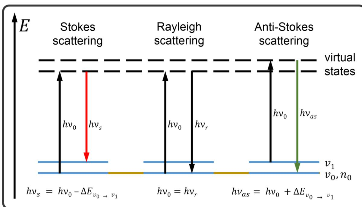
**Figure 0.1.** Représentation schématisée de l'effet Raman.  $\nu_0$  et  $\nu_1$  représentent l'état vibratoire fondamental et le premier état vibratoire excité d'une molécule. Les flèches noires représentent l'énergie  $h\nu_0$  et  $h\nu_r$  d'un photon incident ainsi que l'énergie d'un photon diffusé de Rayleigh. La flèche rouge représente l'énergie  $h\nu_s$  d'un photon diffusé de Stokes, la flèche verte symbolise l'énergie d'un photon diffusé Anti-Stokes  $h\nu_{as}$ .
