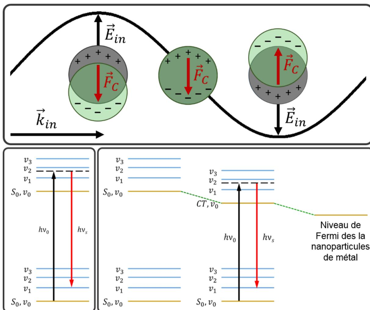
**Figure 0.2.** Haut : Représentation schématique de la résonance plasmonique de surface localisée (LSPR). En bas à gauche : Représentation schématique de l'effet Raman de résonance. En bas à droite : Représentation schématique de l'effet chimique de transfert de charge par résonance.
