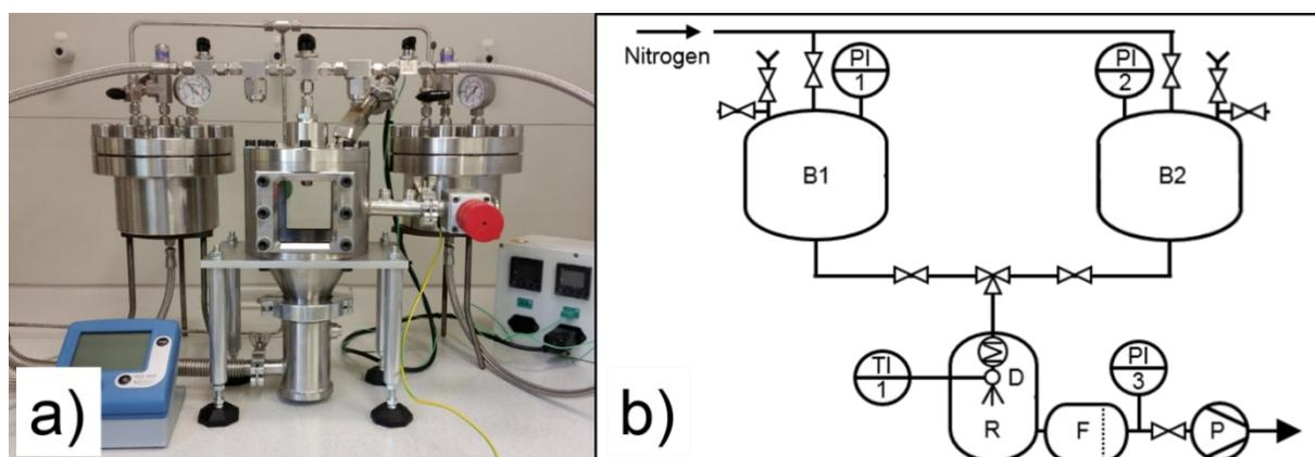
**Figure 0.4.** a) Photographie d'une version de laboratoire SFE - réacteur. b) Schéma du SFE. B1, B2 : réservoir de solvant et de solution ; R : chambre de réaction ; D : buse à cône creux, F : filtre, P : pompe à vide ; PI : capteur de pression ; TI : capteur de température.
