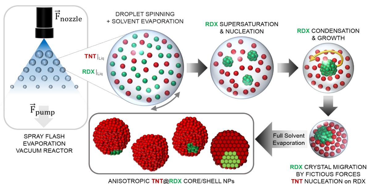
**Figure 0.10.** Schéma du mécanisme supposé de formation des nanoparticules anisotropes RDX/TNT de type cœur/coquille. La particule de droite dans l'encadré est représentée en coupe transversale pour illustrer l'anisotropie des nanoparticules d'hexolite cœur/coquille.
