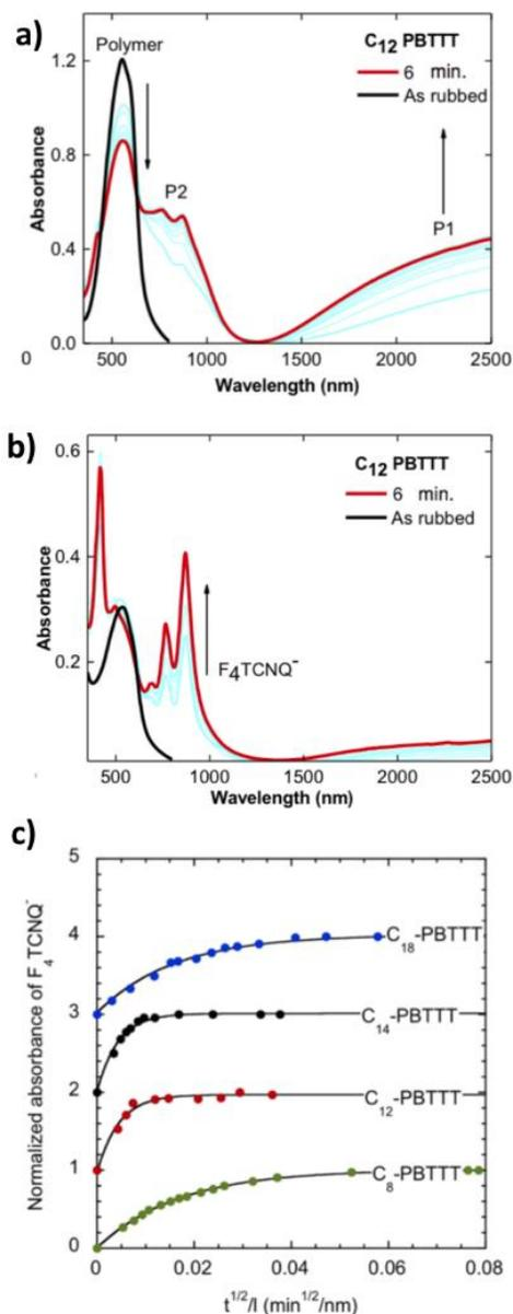
**Figure 3.** a) et b) Cinétique de dopage de films minces de  $C_{12}$ -PBTTT suivie par spectroscopie polarisée UV-vis-NIR avec la polarisation POL //R et POL perpendiculaire à R, respectivement. C) Cinétiques de dopage de films orientés de PBTTTs portant des chaînes alkyls de longueurs différentes ( $C_8$  à  $C_{18}$ ) en solution de  $F_4TCNQ/ACN$  (1 mg/ml) obtenues à partir de l'absorbance de  $F_4TCNQ^-$  à 875 nm.
