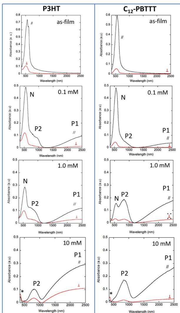
**Figure 9.** Evolution du spectre UV-vis-NIR polarisé pour des films orientés de P3HT et C<sub>12</sub>-PBTTT alignés par brossage à haute température et dopés en solution de FeCl<sub>3</sub>/nitrométhane de concentration croissante. La polarisation de la lumière est soit parallèle (//), soit perpendiculaire (⊥) à la direction de brossage R.
