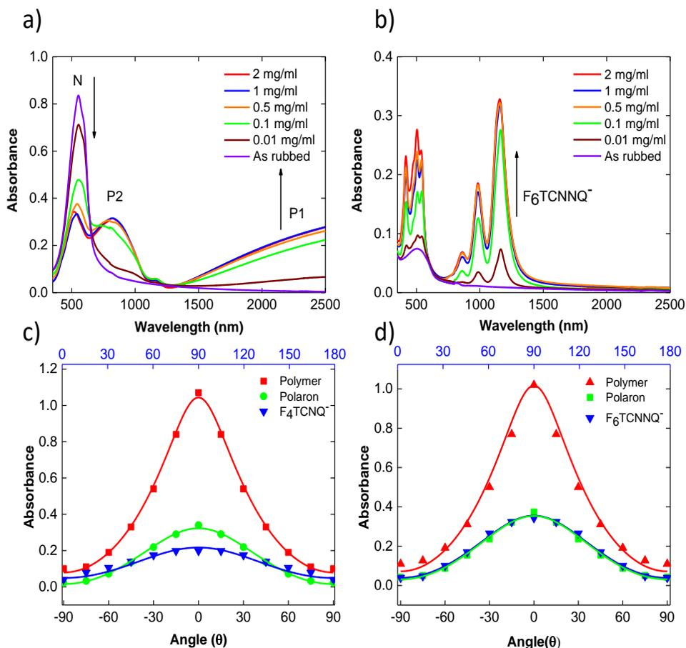
**Figure 12.** Spectres UV-Vis-NIR de films orientés de  $C_{12}$ -PBTTT dopé avec  $F_6TCNNQ$  en fonction de la concentration de dopant dans l'acétonitrile. a) spectres mesurés dans la direction du brossage ( $//$ ) et b) dans la direction perpendiculaire au brossage ( $\perp$ ). c) et d) intensités des bandes caractéristiques des anions  $F_4TCNQ^-$  et  $F_6TCNNQ^-$  des chaînes de  $C_{12}$ -PBTTT (avant dopage) et du polaron (P1) en fonction de l'angle de polarisation.
