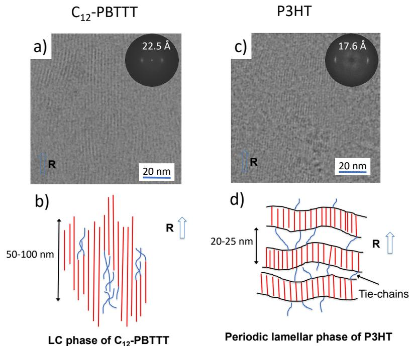
**Figure 7.** Comparaison des structures liquide cristalline et semi-cristalline du  $\text{C}_{12}$ -PBTTT et du P3HT, respectivement. a) et c) images obtenues en mode low dose et haute résolution des films minces alignés et dopés de  $\text{C}_{12}$ -PBTTT. b) et d) illustration des structures liquide cristalline et semi-cristalline du  $\text{C}_{12}$ -PBTTT et du P3HT, respectivement.
