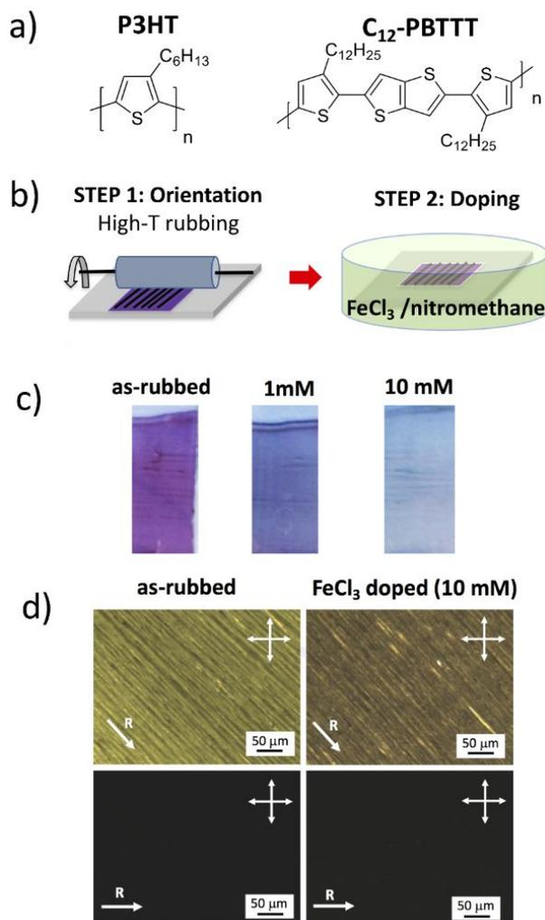
**Figure 6.** a) Structures chimique du P3HT et du PBTTT étudiés. b) Méthode de préparation des couches orientées conductrices par brossage à haute température et dopage en solution de FeCl<sub>3</sub>/nitrométhane. c) Evolution de la couleur des couches minces en fonction du dopage à 1mM et 10mM. d) Comparaison des biréfringences des films brossés de C<sub>12</sub>-PBTTT avant et après dopage avec FeCl<sub>3</sub>.
