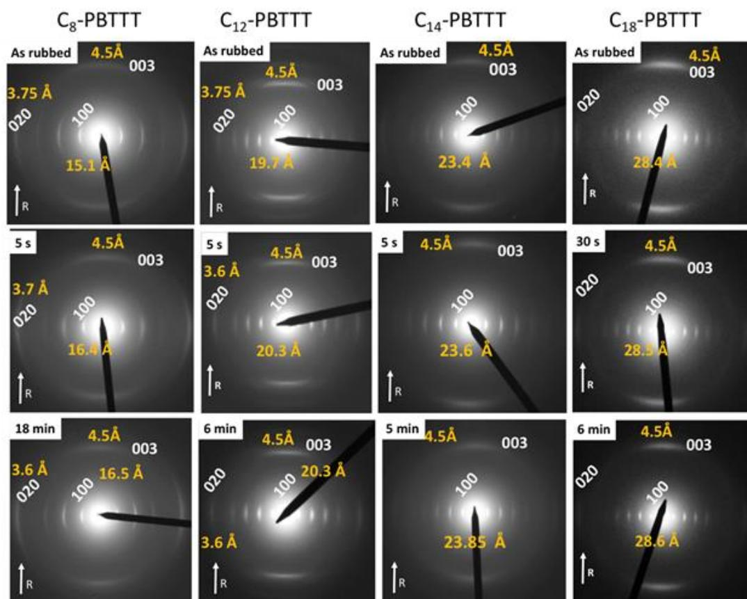
**Figure 4.** Evolution des clichés de diffraction électronique de films minces de différents PBTTTs orientés par brossage ( $T_R=125^\circ\text{C}$ ) et dopés avec  $F_4\text{TCNQ}$  pour différents temps de dopage. Les distances réticulaires correspondant à la périodicité lamellaire (le long des chaînes alkyls)  $d_{100}$  et selon le  $\pi$ -stacking  $d_{020}$  sont notées en bleu. La flèche R indique la direction de brossage des films minces.
