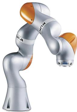
FIGURE 1.1 – Le robot sériel collaboratif LBR iiwa, KUKA.
