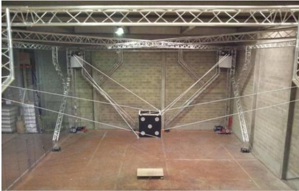
FIGURE 1.3 – Le robot parallèle à câbles CoGiRo, LIRMM.
