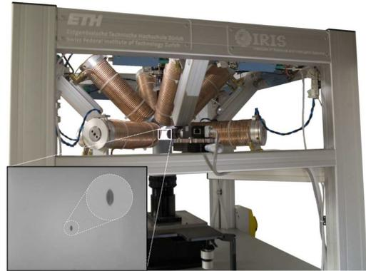
FIGURE 5.3 – Le système Octomag [Kummer 2010].
