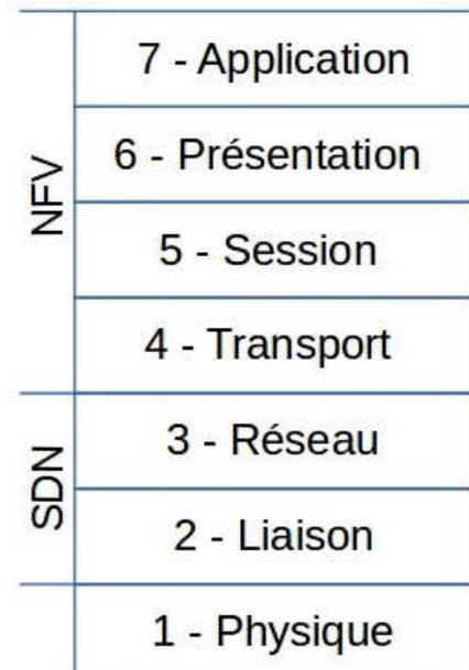
FIGURE 2.3 – Les couches du modèle OSI
