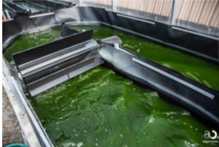
Figure 1 : Open raceway de l'entreprise Algosource Technologies pour la production de Spiruline
