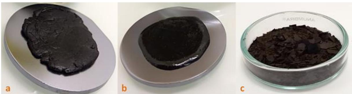
Figure 3-5 : Fractionnement de la phase hydrophobe obtenue après 60 min (a), en phase huileuse (b) et résidus solides (c)
