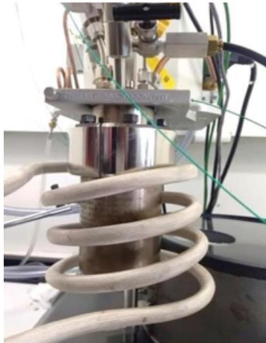
Figure 2-9 : Montage expérimental du réacteur avec le système inductif
