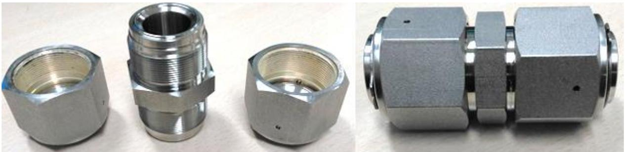
Figure 6 : Réacteur Swagelok ouvert (à gauche) et fermé (à droite)
