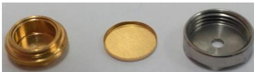
Figure 2-13 : Vue éclatée de creusets DSC 30  $\mu$ L hautes pressions : le creuset (à gauche), le joint (au milieu) et l'écrou (à droite)
