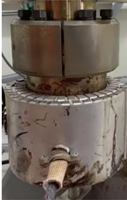
Figure 2-7 : Système de chauffage par collier chauffant
