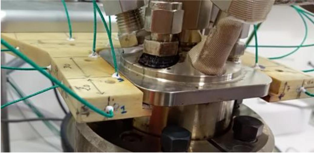
Figure 5 : Réacteur instrumenté sur pièce de maintien isolante
