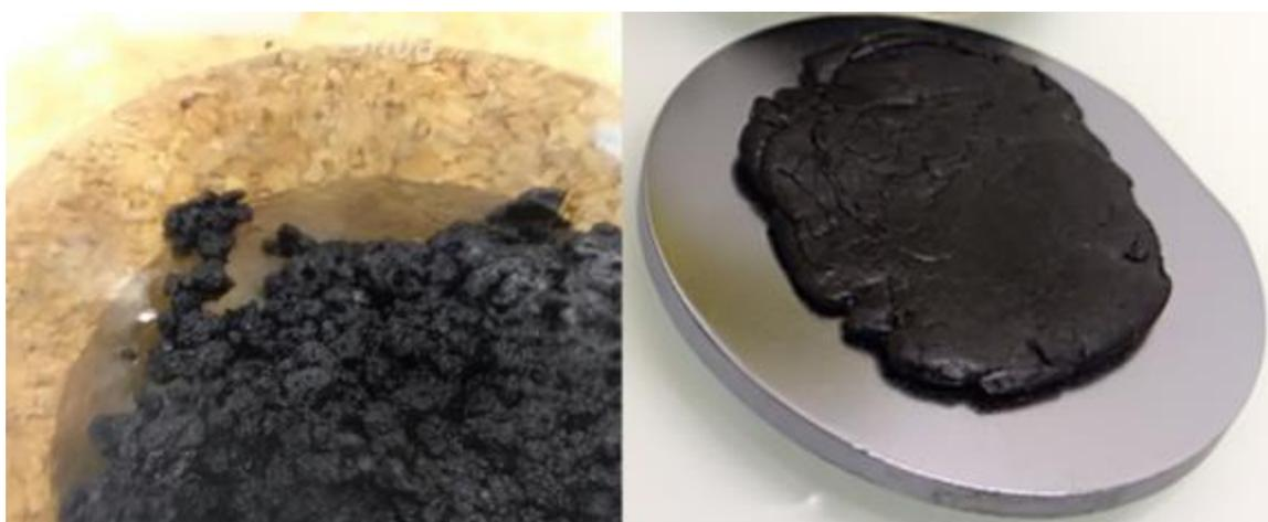
Figure 3-4 : Phase hydrophobe obtenue après 0 min (à gauche) et 60 min (à droite) de temps de réaction
