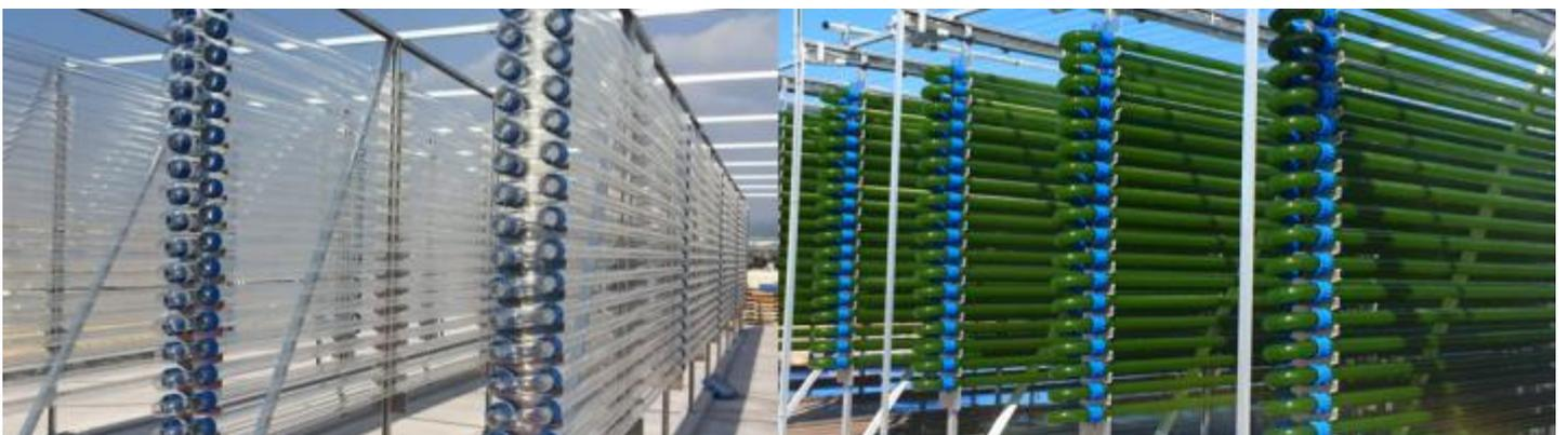
Figure 2 : Photobioréacteurs tubulaires Phyco-Flow™ vide (à gauche) et rempli de microalgues (à droite) [5].
