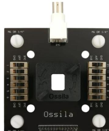
Figure 97. Photographie de la platine de connexion utilisée [209]
