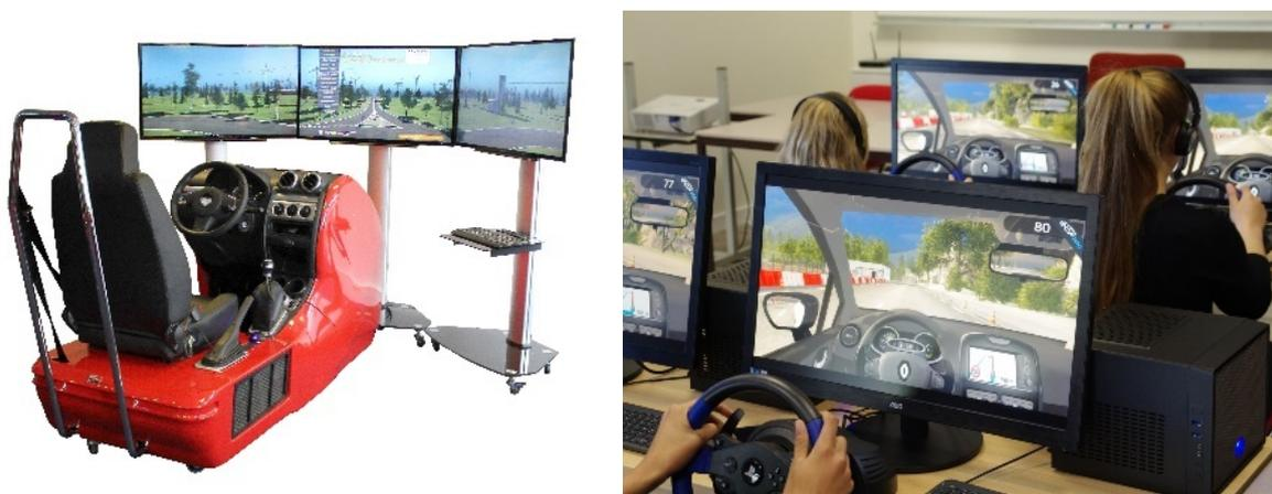
Figure 10, A gauche un simulateur moyenne immersion à 3 écrans de la société DEVELTER © (crédit : [http://www.develter.com/simulateurs-conduite-1\\_FR\\_r\\_40.html](http://www.develter.com/simulateurs-conduite-1_FR_r_40.html)) ; à droite un simulateur basse immersion mono-écran (crédit : <https://www.lyonmag.com> et The Good Drive ©)
