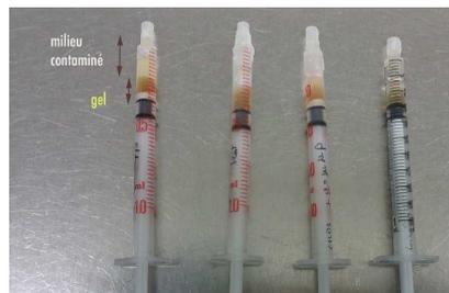
Figure 39 : montage du gel dans des seringues
