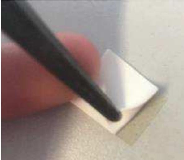
Figure 92 : exemple de délamination entre membrane et film
