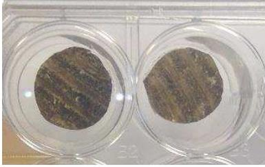
Figure 49 : aspect du Goretex® imprégné en fin d'immersion
