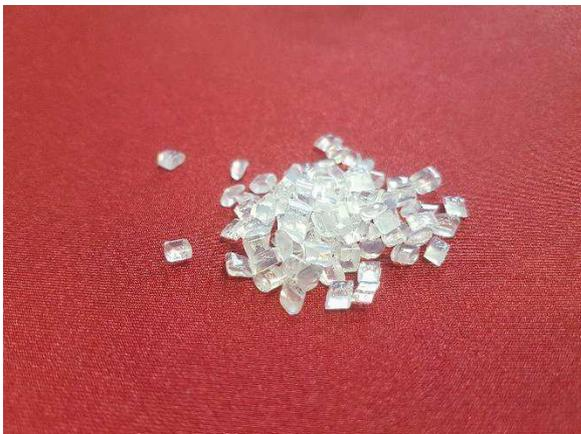
Figure 86 : photographie de granules de TPU à l'état brut
