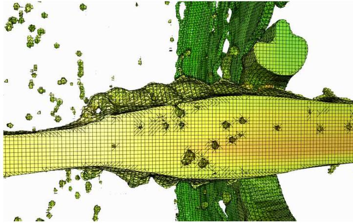
FIGURE 6.1 – Visualisation surfacique composée de lignes et de polygones colorés. Cet exemple représente la reconstruction des surfaces des matériaux d'une simulation de CFD.
