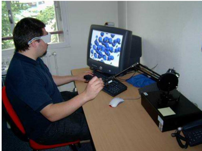
FIGURE 6.15 – Périphérique 3D à retour d'effort (ici un Phantom) utilisé par un doctorant au CEA/DAM.
