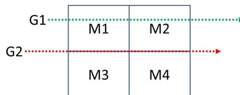
FIGURE 5.6 – Cas pathologique classique d'une trajectographie : un rayon passe dans l'axe de la séparation entre les mailles. Il est donc impossible de savoir dans quelle maille il va entrer (cas du rayon rouge). Le cas du rayon vert est beaucoup plus simple, surtout dans le cas structuré qui est celui du DXFCI2.
