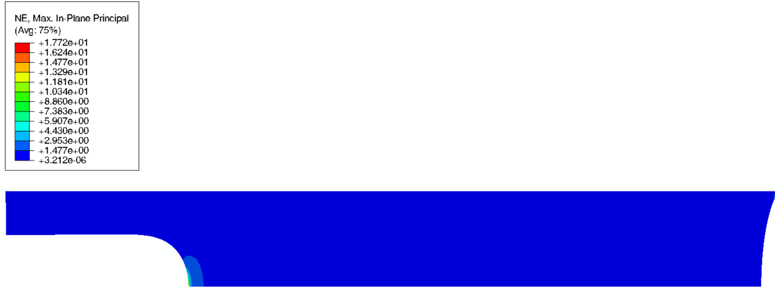
FIGURE 7.19 – Vue de la déformée et des valeurs de déformation nominale principale maximale sur une simulation numérique d'une éprouvette PS pour le cas de chargement 20 mm avec une fissure de 70 mm.
