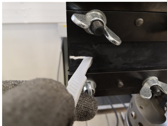
FIGURE 3.23 – Introduction d'une entaille dans une éprouvette PS en EPDM_S à l'aide d'un scalpel.
