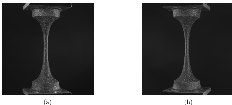
FIGURE A.3 – Vues de l'éprouvette AE2 en EPDM_S déformée à un déplacement imposé de 50 mm (a) pour la caméra de gauche et (b) pour la caméra de droite.
