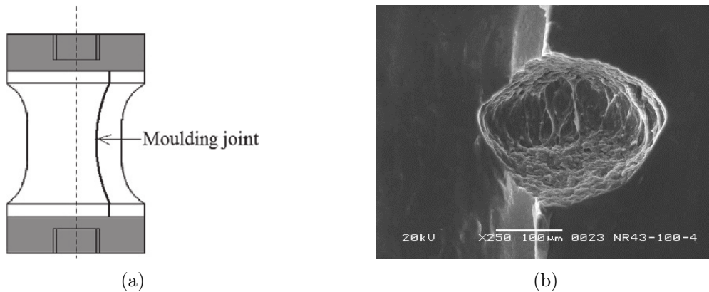
FIGURE 5.2 – (a) Schéma représentant la bavure d'une éprouvette diabolo en polychloroprène renforcé au noir de carbone (Poisson et al. , 2011) et (b) cliché MEB d'une fissure de fatigue sur la bavure d'une éprouvette AE2 dans un NR renforcé au noir de carbone (Masquelier, 2014).
