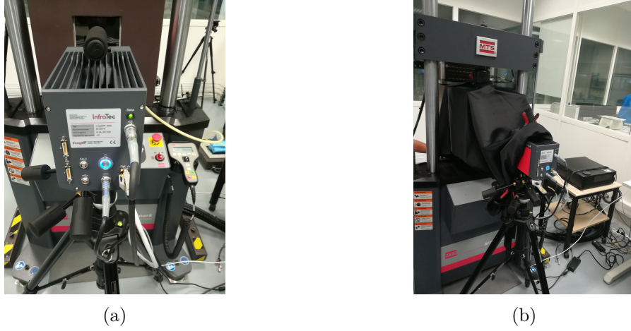
FIGURE 4.8 – (a) Installation de la caméra infrarouge en face de l'éprouvette derrière la vitre et (b) mise en place du drap occultant pour isoler le montage des rayonnements extérieurs.
