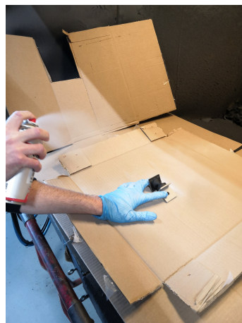
FIGURE A.1 – Projection de peinture blanche permettant de construire un mouchetis sur une éprouvette AE2 en EPDM_S.
