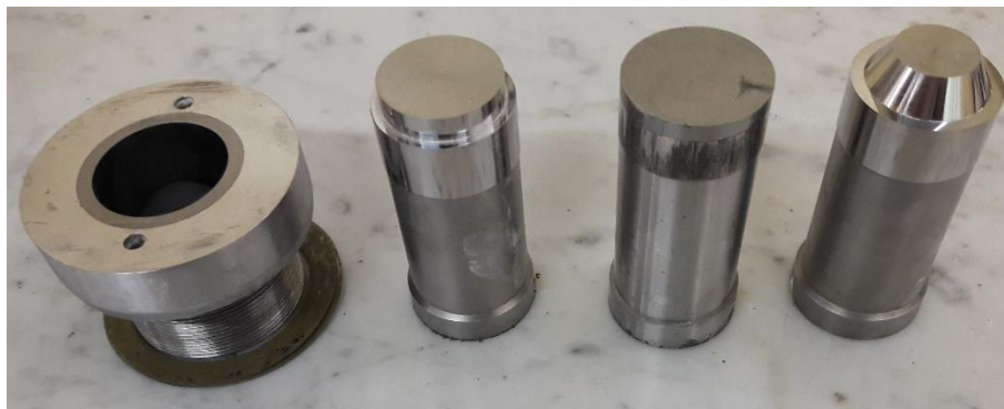
Figure III.35. La matrice et les poinçons utilisés pour le pressage de 34 mm de diamètre
