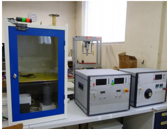
Figure II.38. Dispositif de test électrique de décharges partielles
