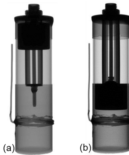
Figure II.7. Vues aux rayons X du condensateur A.
