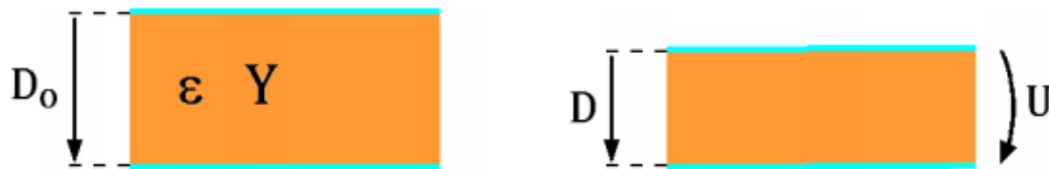
Figure I.21. Représentation schématique d'un claquage électromécanique
