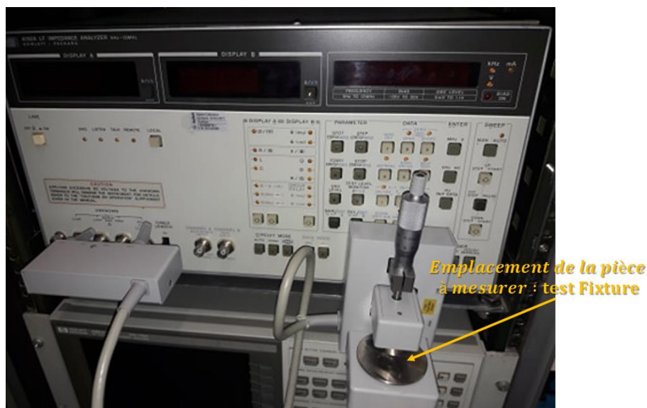
Figure III.7. Dispositif de mesure de la permittivité entre 100Hz et 13MHz
