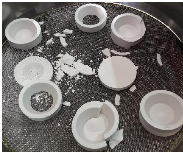
Figure III.37. Fissuration des pièces pressées avec l'embout conique (34 mm, 30^\circ )
