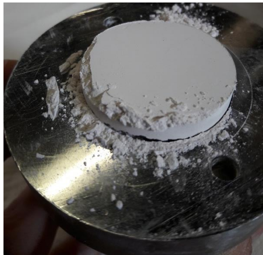
Figure III.30. Pièce pressée avec 43% de grains fins et 57% de gros grains
