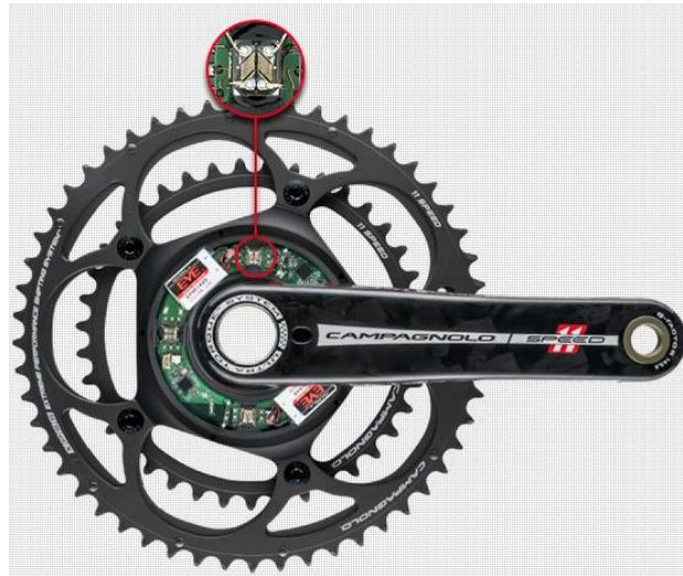
Figure 55. Illustration d'un pédalier instrumenté de la marque SRM avec en loupe une de ses jauges de contraintes (@SRM.de)
