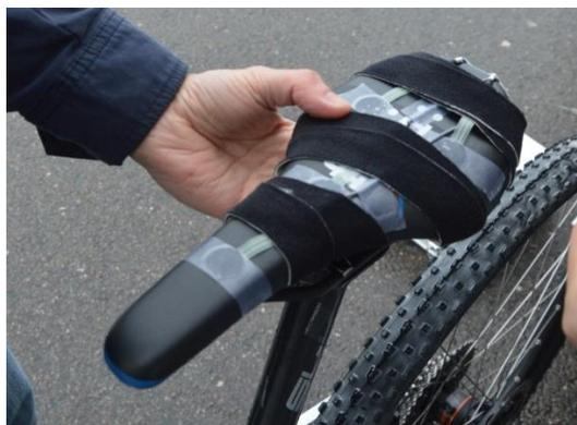
Figure 45 – Disposition des capteurs de pression sur l'assise
