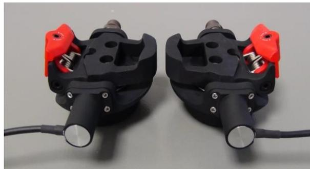
Figure 57. Photographie de pédales instrumentées de laboratoire (*@I-Crankset, Sensix*)
