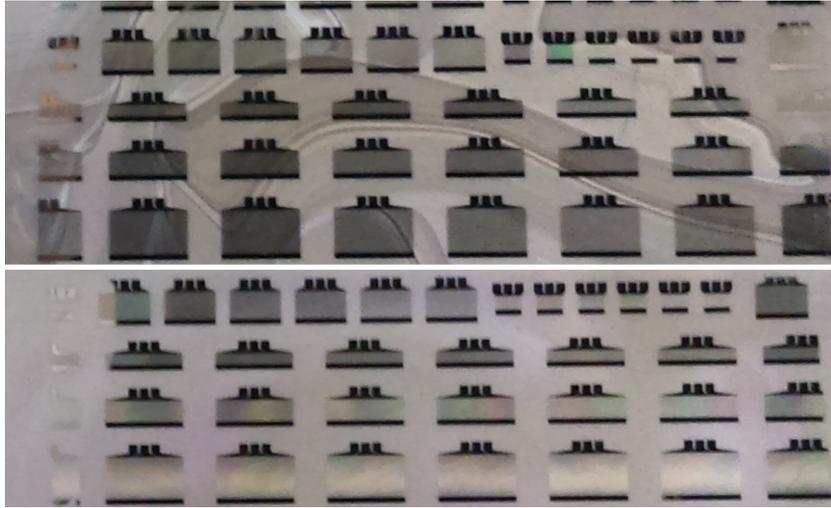
FIGURE 4.14 – Résonateurs sur STS après fabrication
