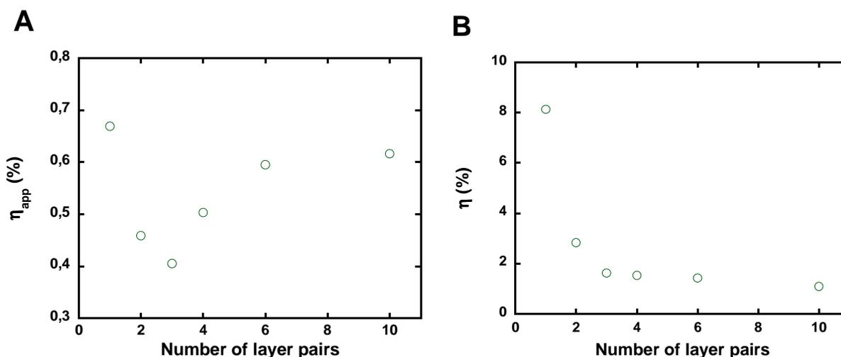
Fig. 8: Rendement quantique apparent (A) et efficace (B) des films PEI/(PSS/TiO<sub>2</sub>)<sub>n</sub> en fonction du nombre de paires de couches. Le rendement quantique apparent se réfère à la quantité de photons reçue par le film, tandis que le rendement quantique efficace fait référence à la quantité de photons absorbée par le film.
