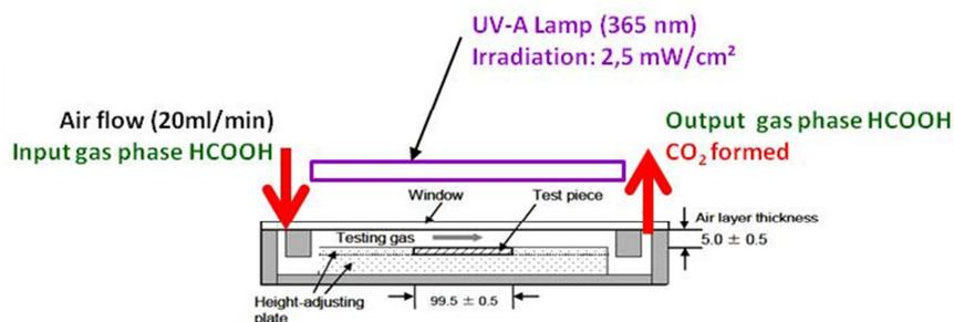
Fig. 3: Représentation schématique du réacteur photocatalytique dérivé du standard ISO 22197.
