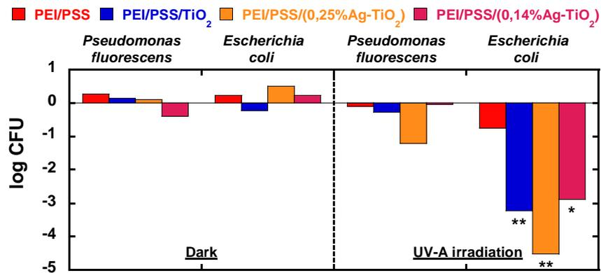
Fig. 20: Tests antibactériens des films multicouches PEI/PSS/(Ag-TiO<sub>2</sub>). Bactéries testées : Pseudomonas fluorescens et Escherichia Coli K12, UV-A (2.5 mW/cm<sup>2</sup>), temps d'irradiation = 3 h, textiles en fibre de polyester de 2 cm<sup>2</sup>. Tests effectués selon la norme BS ISO 27447. p: p-value ; (\*) p < 0.01, (\*\*) p < 0.001
