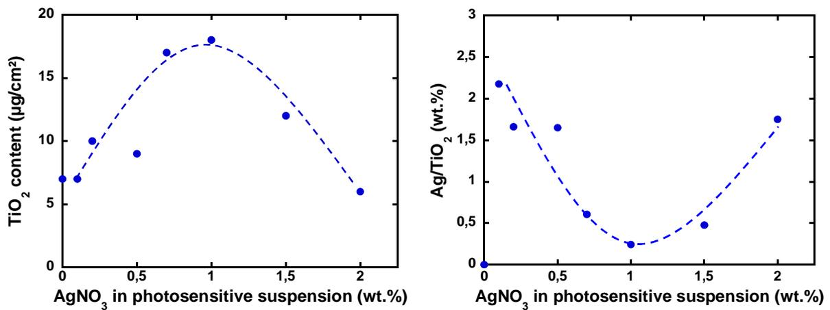
Fig. 12: Teneur en TiO<sub>2</sub> (gauche) et rapport massique Ag/TiO<sub>2</sub> (droite) des films hybrides PEI/PSS/(Ag-TiO<sub>2</sub>) en fonction de la concentration en AgNO<sub>3</sub> dans la suspension photosensible.
