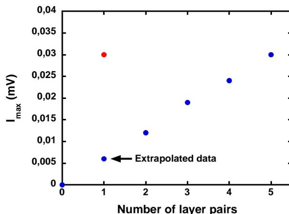
Fig. 14: Valeur de l'intensité maximale  $I_{max}$  caractéristique dérivée des mesures de TRMC sur les films PEI/(PSS/TiO<sub>2</sub>)<sub>n</sub> (•) et PEI/PSS/(Ag-TiO<sub>2</sub>) (•). Irradiation laser à 350 nm.
