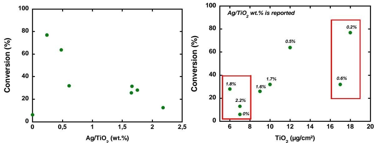
Fig. 13: Résultats des tests photocatalytiques de dégradation de HCOOH en phase gazeuse (gauche) en fonction du rapport massique Ag/TiO<sub>2</sub>, et (droite) en fonction de la teneur en TiO<sub>2</sub> dans les films PEI/PSS/(Ag-TiO<sub>2</sub>). Conditions expérimentales : [HCOOH] = 255 ppm<sub>v</sub>, débit total = 20 mL/min, UV-A (2.5 mW/cm<sup>2</sup>), substrat modèle de 36 cm<sup>2</sup>.
