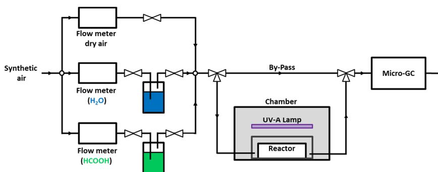
Fig. 4: Schéma du montage du test photocatalytique pour la dégradation de l'acide formique en phase gazeuse.
