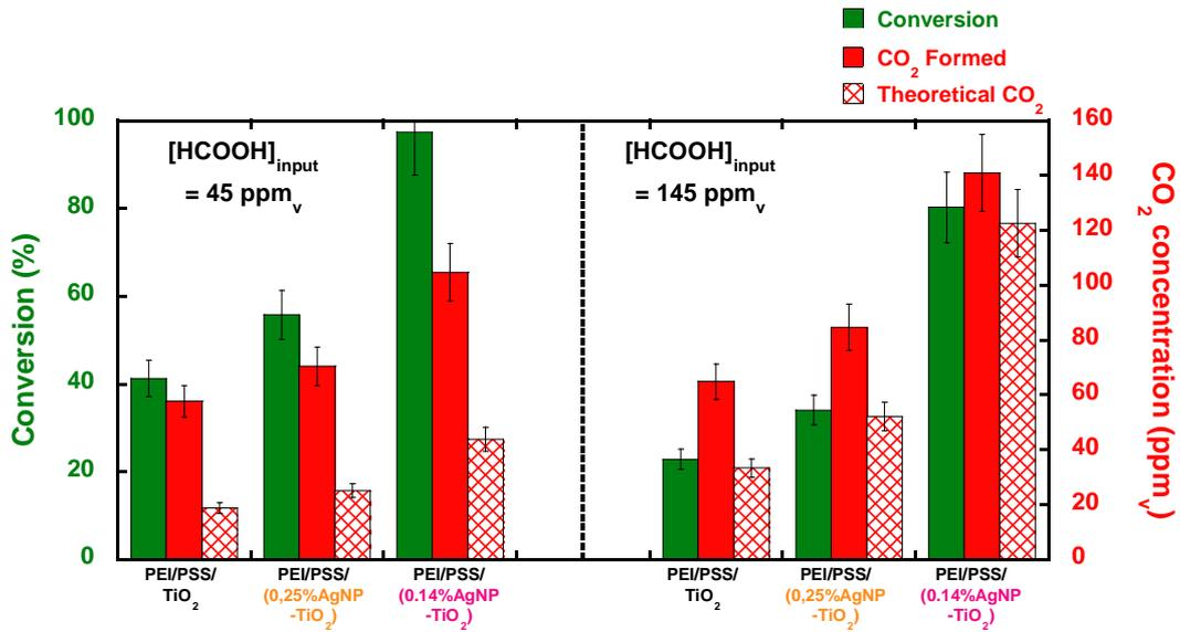
Fig. 19: Test photocatalytiques pour la dégradation de HCOOH en phase gazeuse pour les films PEI/PSS/(Ag-TiO<sub>2</sub>) construits sur textiles. Conditions expérimentales : [HCOOH] = 45 ppm<sub>v</sub> (à gauche), 145 ppm<sub>v</sub> (à droite), débit total = 20 mL/min, UV-A (2.5 mW/cm<sup>2</sup>), textiles en fibre de polyester de 36 cm<sup>2</sup>.
