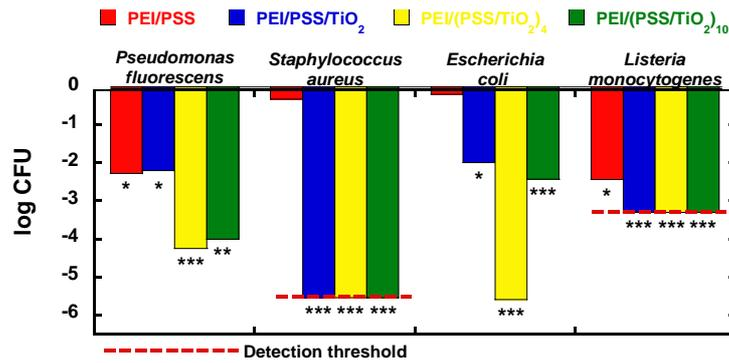
Fig. 18: Tests antibactériens des films multicouches PEI/(PSS/TiO<sub>2</sub>)<sub>n</sub>. Bactéries testées : *Pseudomonas fluorescens*, *Staphylococcus aureus*, *Escherichia Coli* K12 et *Listeria monocytogenes*, UV-A (2.5 mW/cm<sup>2</sup>), temps d’irradiation = 3 h, textiles en fibre de polyester de 2 cm<sup>2</sup>. Tests effectués selon la norme BS ISO 27447. p : p-value ; (\*) p < 0.05, (\*\*) p < 0.001, (\*\*\*) p < 0.0001
