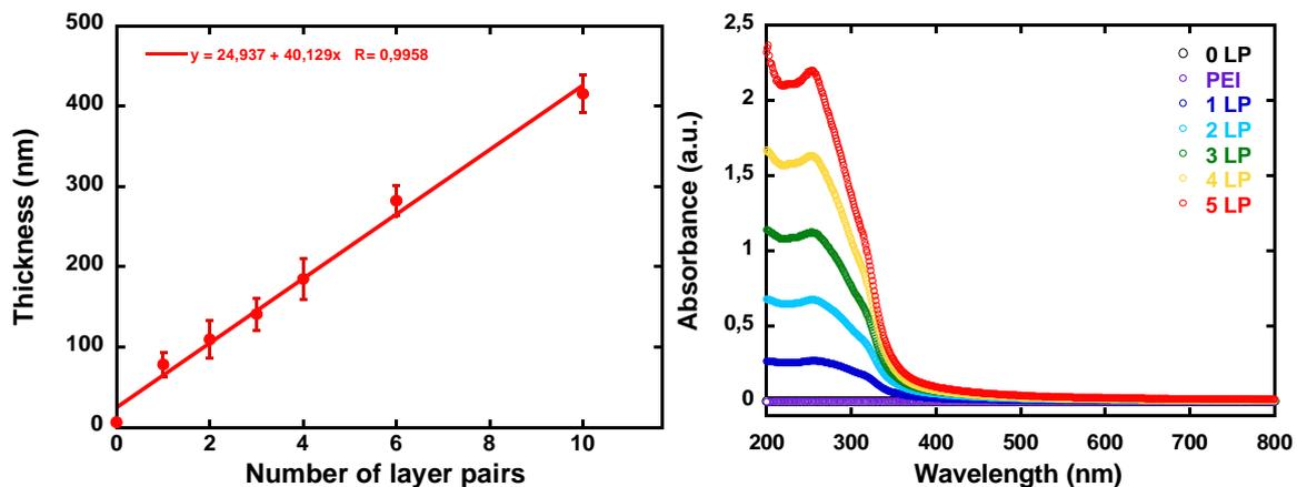
Fig. 5: Suivi de la construction des films PEI/(PSS/TiO<sub>2</sub>)<sub>n</sub> (à gauche) par ellipsométrie pour des films construits sur wafer de silicium, (à droite) par spectrophotométrie UV-Visible pour des films construits sur des lamelles de quartz.
