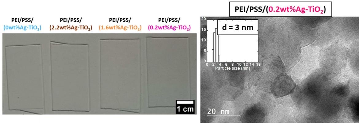
Fig. 11: (Gauche) Image des films PEI/PSS/(Ag-TiO<sub>2</sub>) construits sur lamelle de verre. (Droite) Caractérisation par microscopie électronique en transmission de l'échantillon PEI/PSS/(0.2wt%Ag-TiO<sub>2</sub>)
