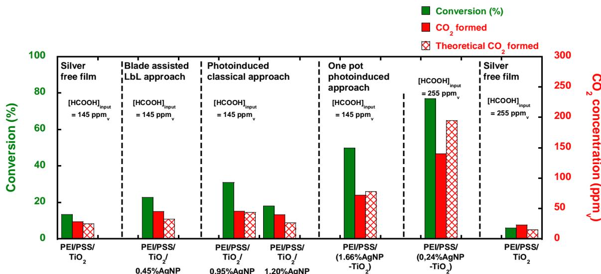
Fig. 15: Comparaison des performances photocatalytiques des films PEI/PSS/(Ag-TiO<sub>2</sub>) préparés selon les 3 différentes méthodes. Conditions expérimentales : débit total = 20 mL/min, UV-A (2.5 mW/cm<sup>2</sup>), substrat modèle de 36 cm<sup>2</sup>.
