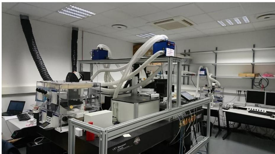
Figure 83. Photo du microscope confocal équipé d'un laser femtoseconde utilisé pour la PDT par excitation biphotonique.
