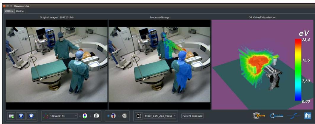
Figure D.14: Visualisation par réalité augmentée de la dose sur les différentes parties du corps des cliniciens présents dans la salle pour l'angle d'incidence courant du capteur plan, proposée par le système *XAware-Live*.
