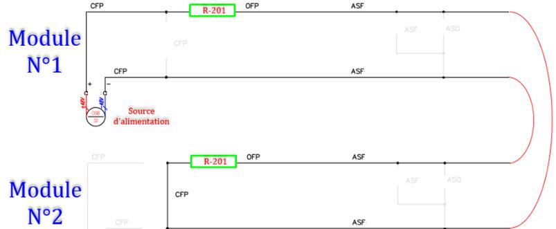
**Cas 2 :** Le module N°1 alimente toujours la boucle FP, le module N°2 est par contre shunté et ne reçoit plus de courant. La boucle FP étant toujours fermée, le courant I circule mais uniquement aux bornes du module N°1. Par conséquent seul le relais du module N°1 est excité.
