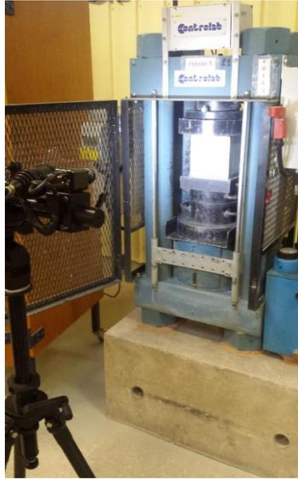
**Figure 4.7 :** Machine de compression associée au système de mesure 3D de déformations sans contact par stéréo-corrélation d'images ARAMIS.
