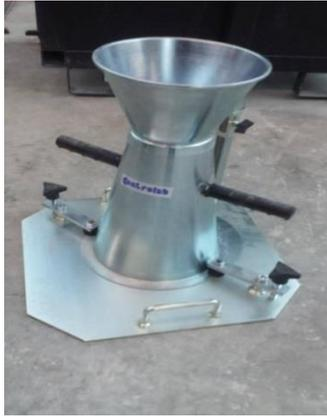
**Figure 4.6 :** Cône d'Abrams.
