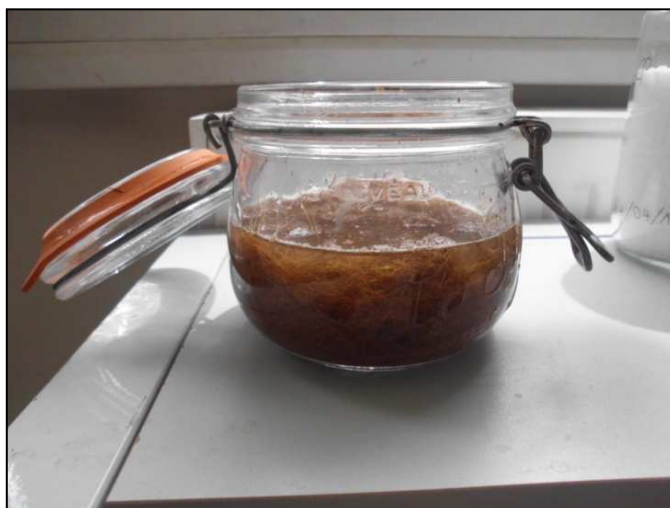
Figure 2.5: Fibres de Posidonia-Oceanica dans une solution de soude
