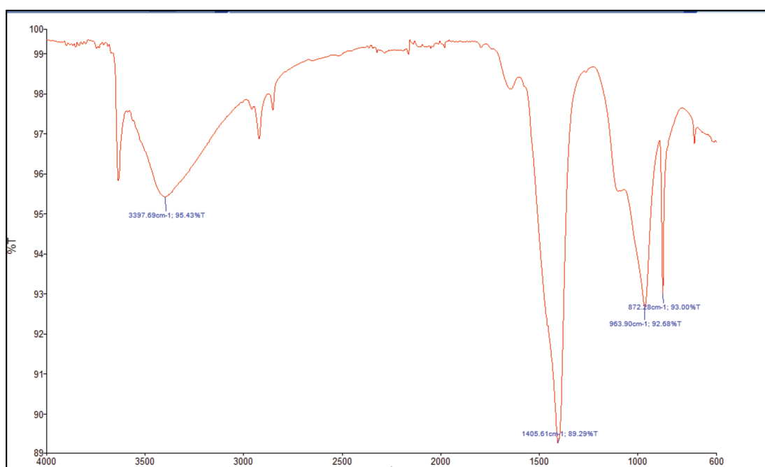
Figure 4.2: Spectre d'un composite : pâte de ciment avec 20% de fibres (après 28 jours de séchage)
