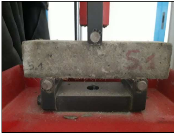
Figure 2.21: Éprouvette de composite sous essai de flexion
