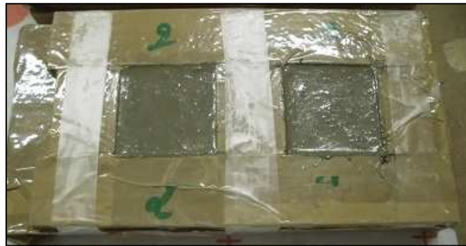
Figure 2.9: Éprouvettes pour essais thermiques et hygrothermiques
