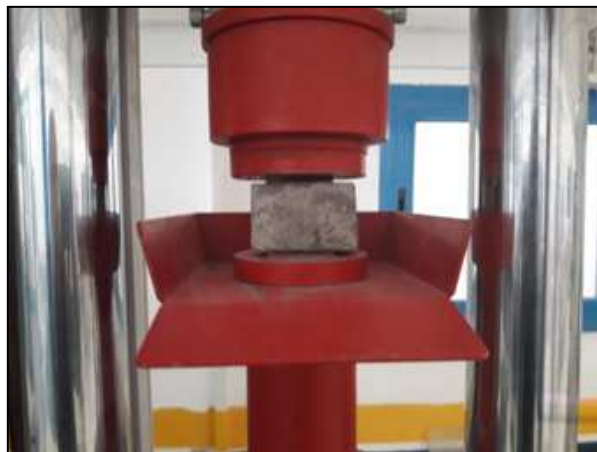
Figure 2.22: Éprouvette de composite sous essai de compression
