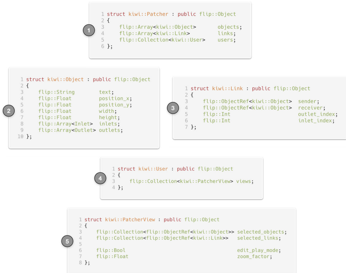
Figure 21 – Représentation simplifiée du modèle de données relatif à un document (un patch) au sein de l'application Kiwi, sous la forme de structure C++ modélisée grâce aux types de base fournis par la bibliothèque flip [Tableau 2]. Une des conventions veut que chaque type personnalisé au sein du modèle de données hérite du type de base flip::Object comme l'illustre ces différentes vignettes. La vignette 1 expose les membres relatifs au Patcher (la classe racine de notre document), la 2 expose ceux d'un objet de base d'un patch Kiwi, la 3 est relative aux liens, la 4 stocke des informations spécifiques à chaque utilisateur du patch, enfin la 5 des informations relatives à la vue graphique du patch.
