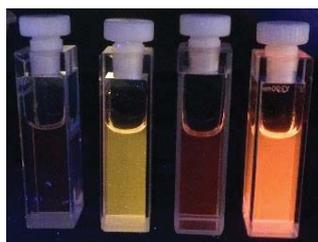
Figure 51 : Photographie de cuves de spectroscopie contenant des solutions de FONs **fpOH**, **19**, **9** et **10** (de gauche à droite) dans l'eau à  $1,45 \text{ mmol.L}^{-1}$  sous irradiation UV ( $\lambda_{exc} = 365 \text{ nm}$ ).
